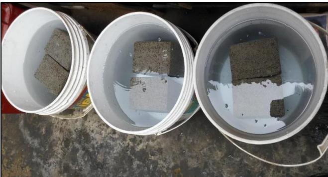
**Foto 12: ladrillos después del curado**
