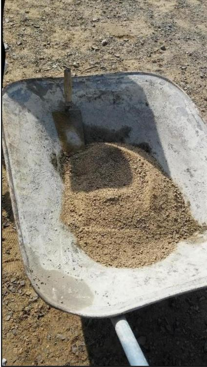
**Foto 10: sustitución del agregado fino por vidrio molido**
