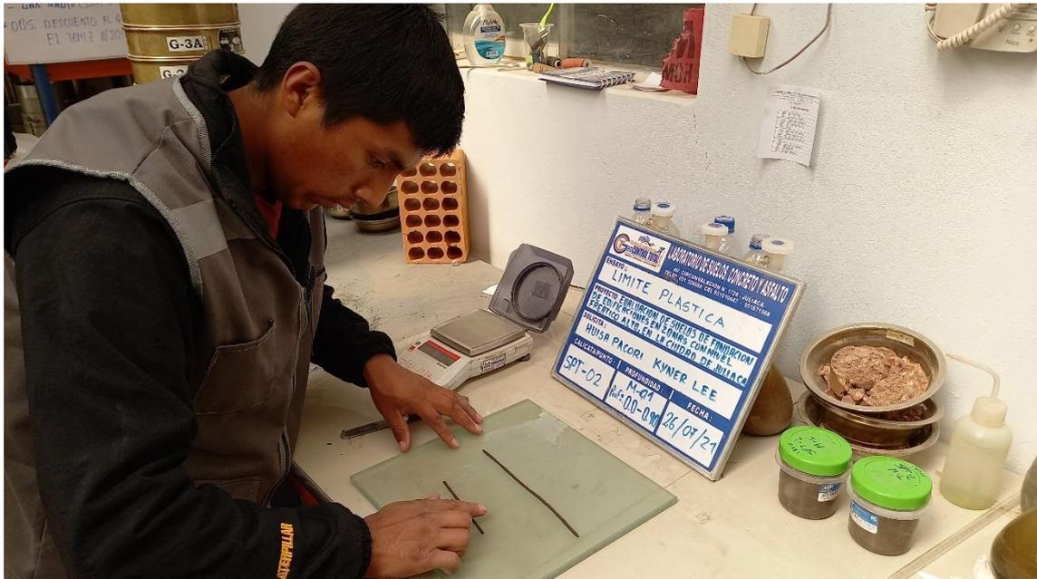
Fotografía 21. Ensayo de Limite plástico, SPT-2, muestra-1.
