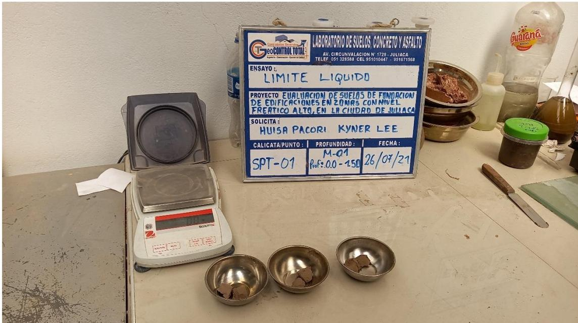
**Fotografía 19.** Pesado de muestras de limite líquido, SPT-1, muestra-1.
