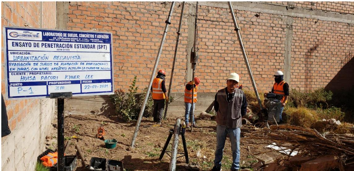
**Fotografía 01.** Ejecución de prueba SPT-1.
