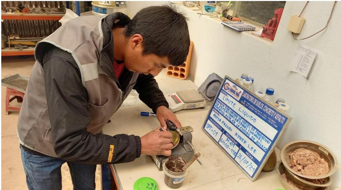
**Fotografía 17.** Ensayo de Limite líquido, SPT-1, muestra-1.
