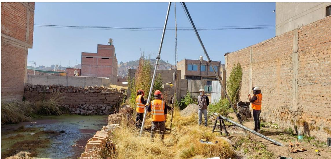
**Fotografía 02.** Ejecución de prueba SPT-2.
