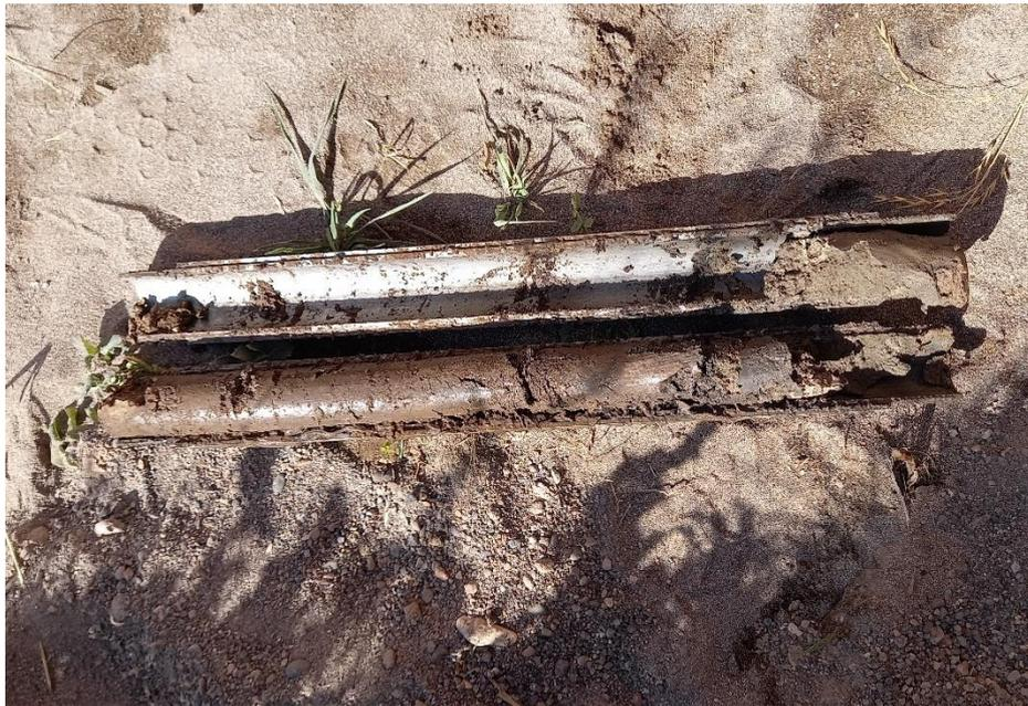
**Fotografía 04.** Muestra extraída a 1.50 m., SPT-1.
