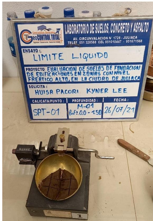
**Fotografía 18.** Resultado de Limite líquido, SPT-1, muestra-1.
