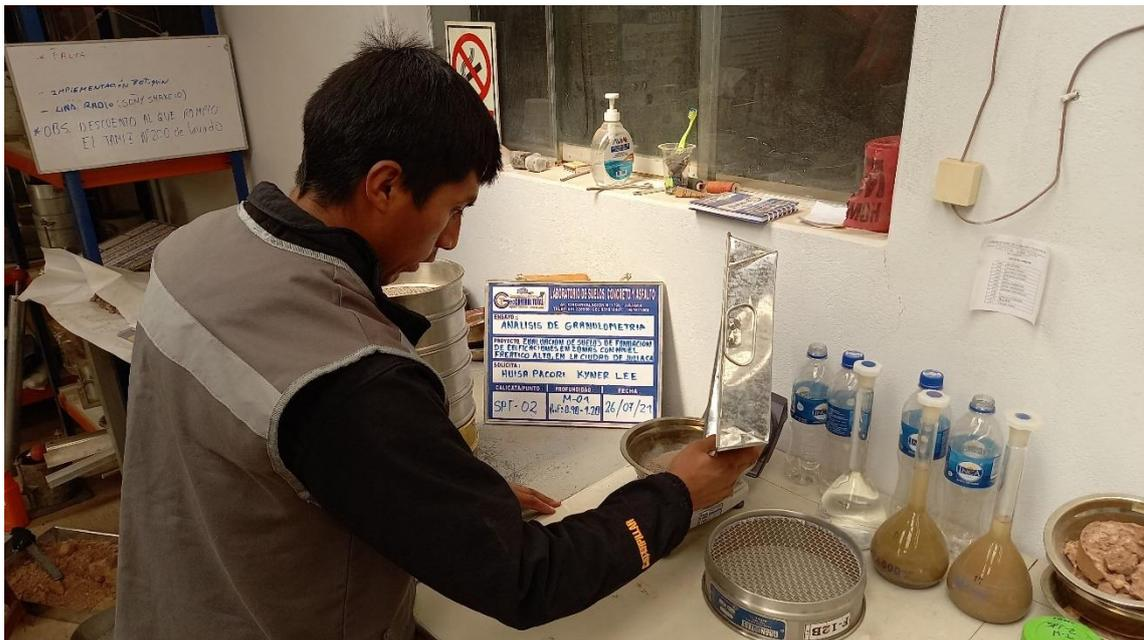
**Fotografía 16. Pesado de material retenido en tamices, SPT-2, muestra-1.**
