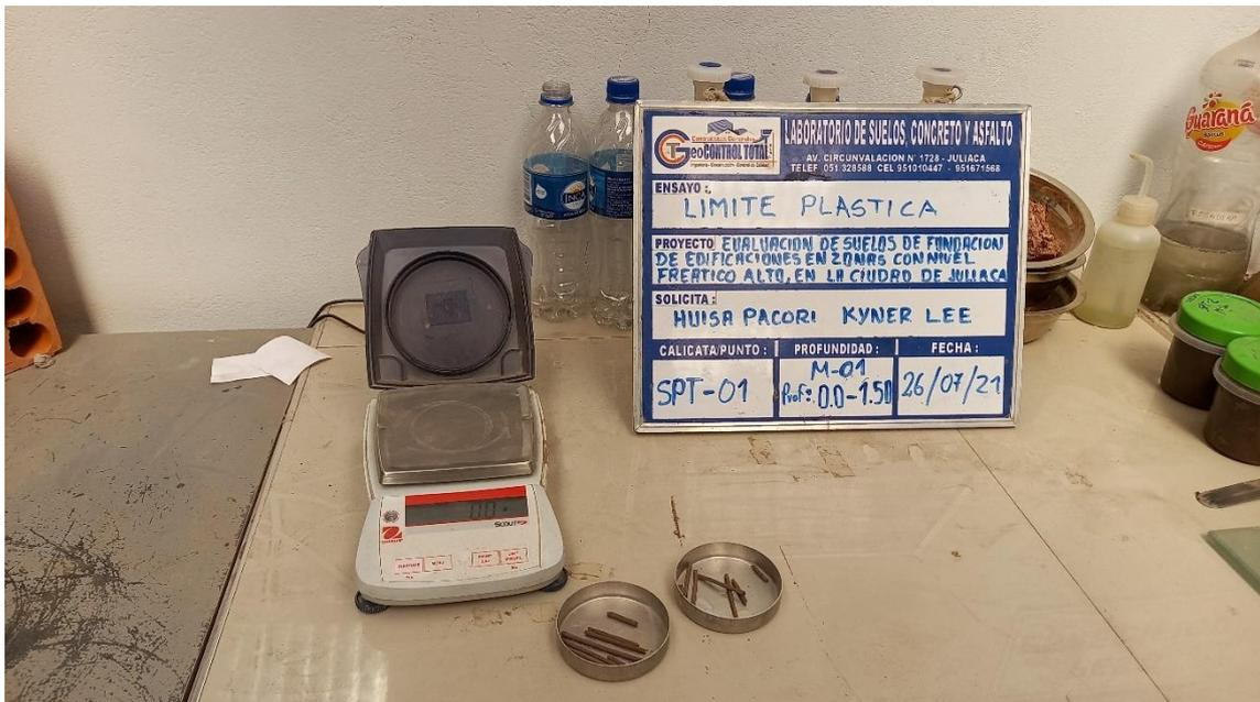
**Fotografía 20.** Pesado de muestras de limite -plástico, SPT-1, muestra-1.
