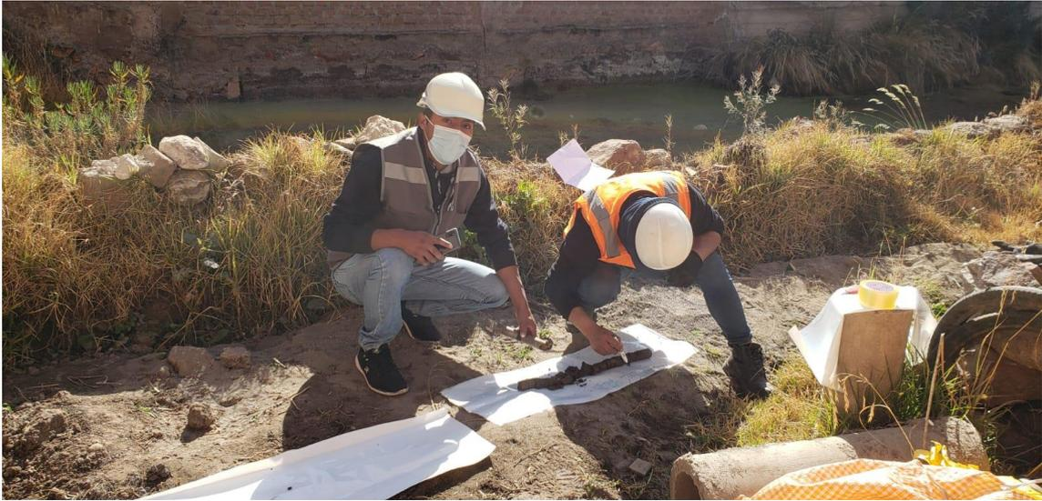
**Fotografía 05.** Muestra extraída a 0.90 m., SPT-2.
