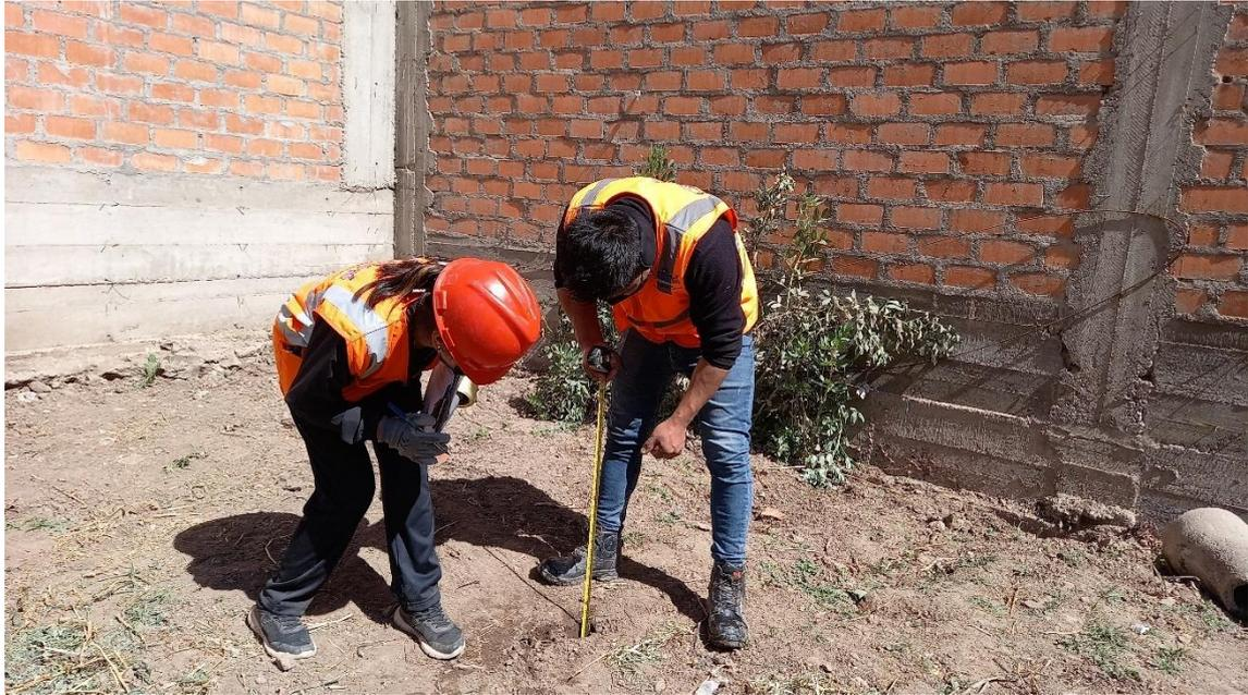
**Fotografía 09.** SPT-2, medición de profundidad de nivel freático.
