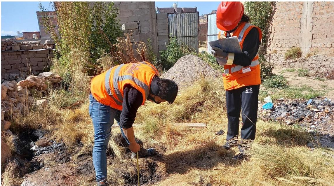
**Fotografía 08.** SPT-1, medición de profundidad de nivel freático.
