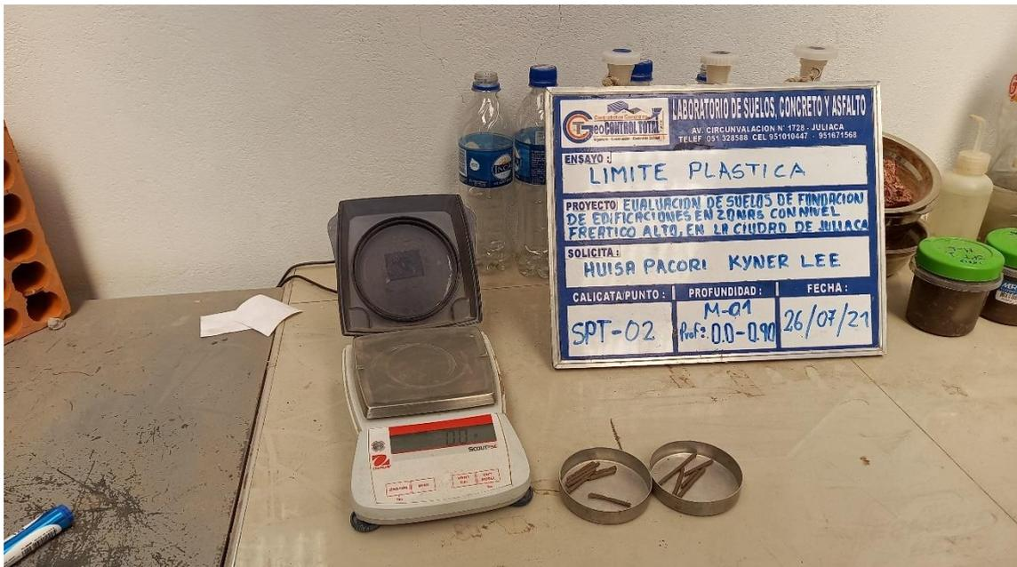
Fotografía 22. Pesado de muestras de limite plástico, SPT-2, muestra-1.
