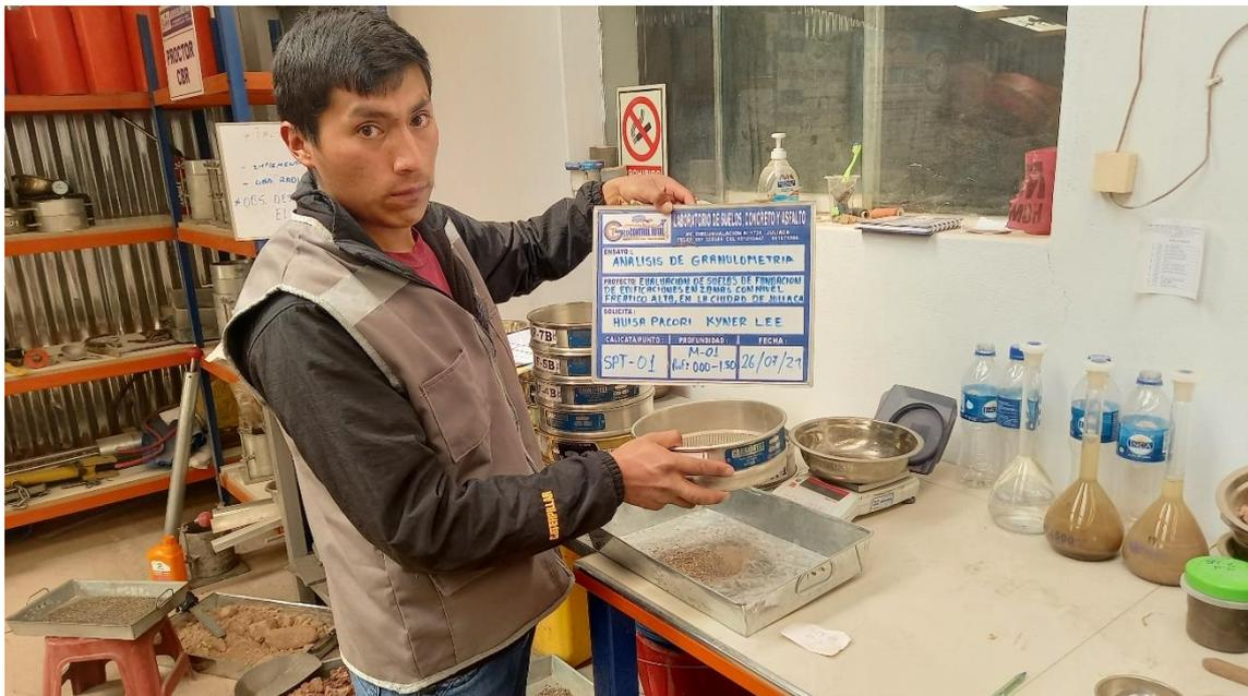
**Fotografía 14.** Ensayo de granulometría, SPT-1, muestra 1.
