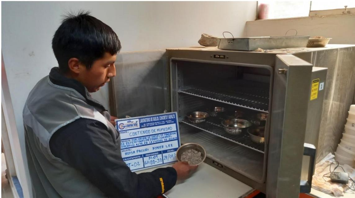
**Fotografía 13.** Secado de muestras para contenido de humedad.
