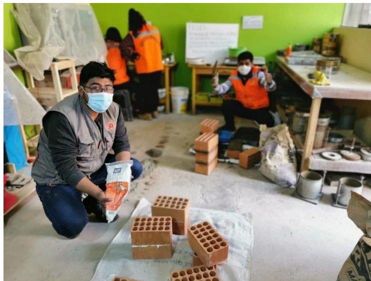
Fotografía 06. Elaboración pilas de ladrillo con mortero polimérico y convencional.
