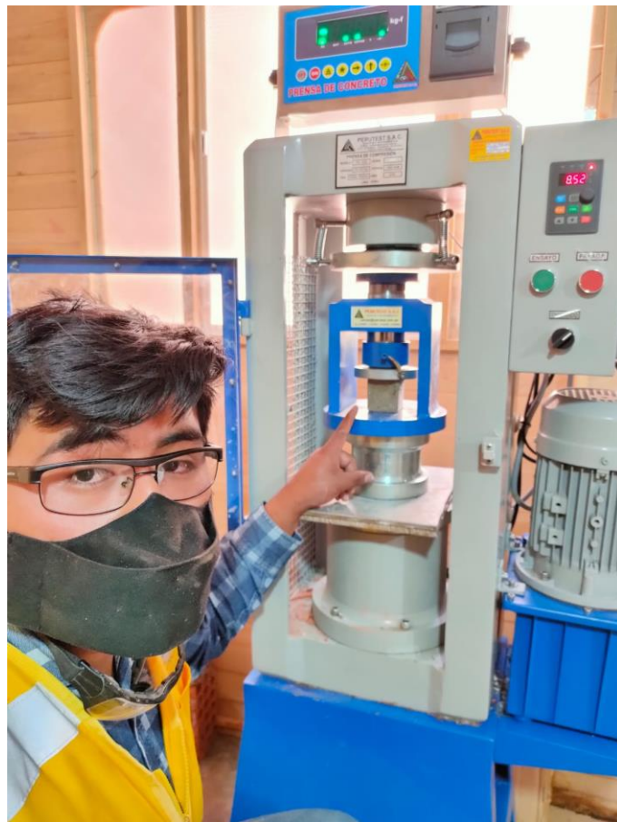
Fotografía 04. Ensayo de compresión de bloques de mortero.
