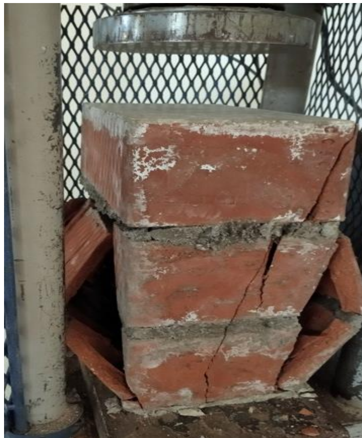
Fotografía 10. Falla de pila de ladrillo con mortero convencional ante aplicación de carga.
