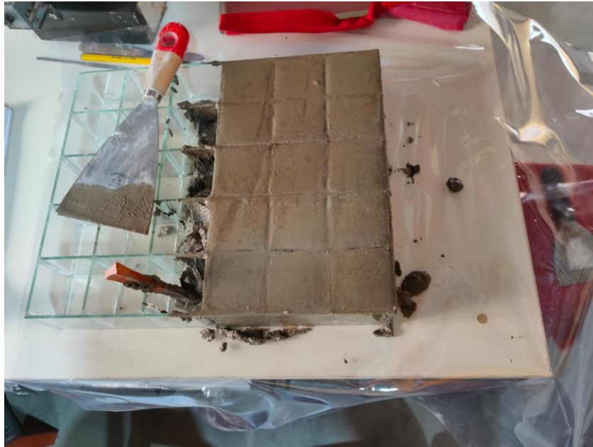
Fotografía 03. Bloques de mortero fresco en el molde.
