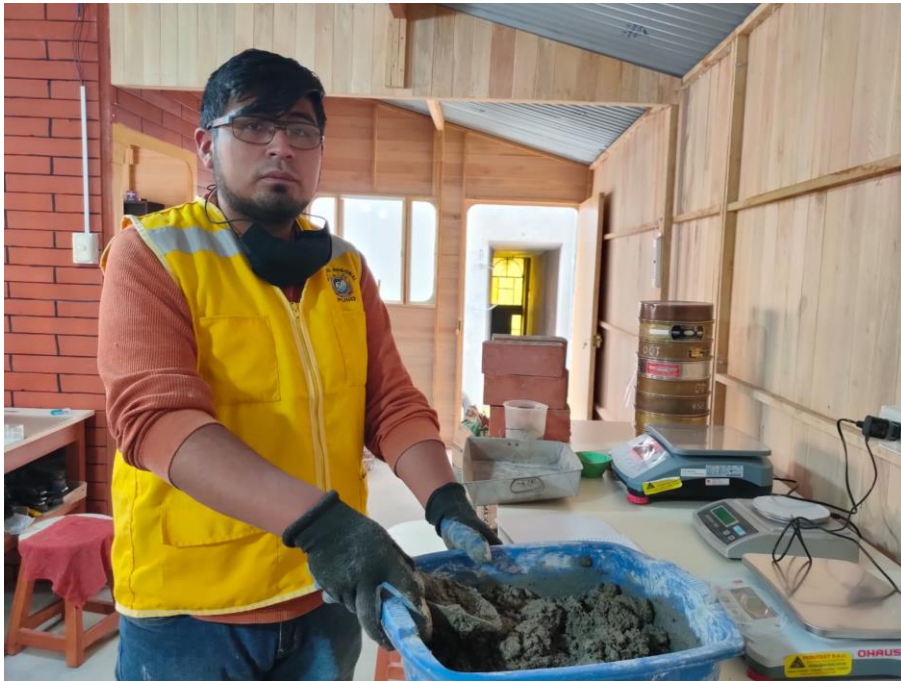
Fotografía 01. Mezclado de mortero (cemento, agregado fino y agua).
