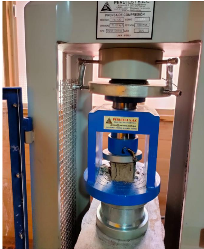
Fotografía 05. Falla ante la aplicación de mayor carga del cubo de mortero.
