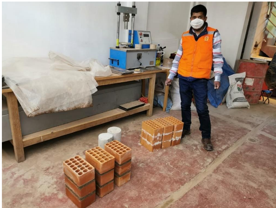
Fotografía 08. Pilas de albañilería con mortero convencional y polimérico.
