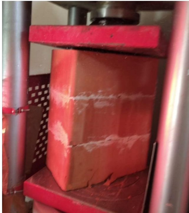
Fotografía 09. Falla de pila de ladrillo con mortero polimérico ante aplicación de carga.
