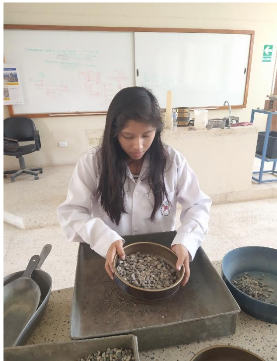
Figura 33. Ensayo de granulometría del agregado grueso
