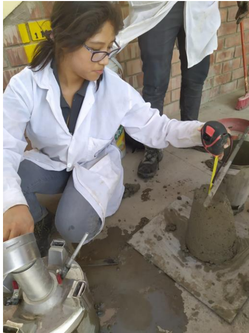
Figura 40. Ensayo de consistencia
