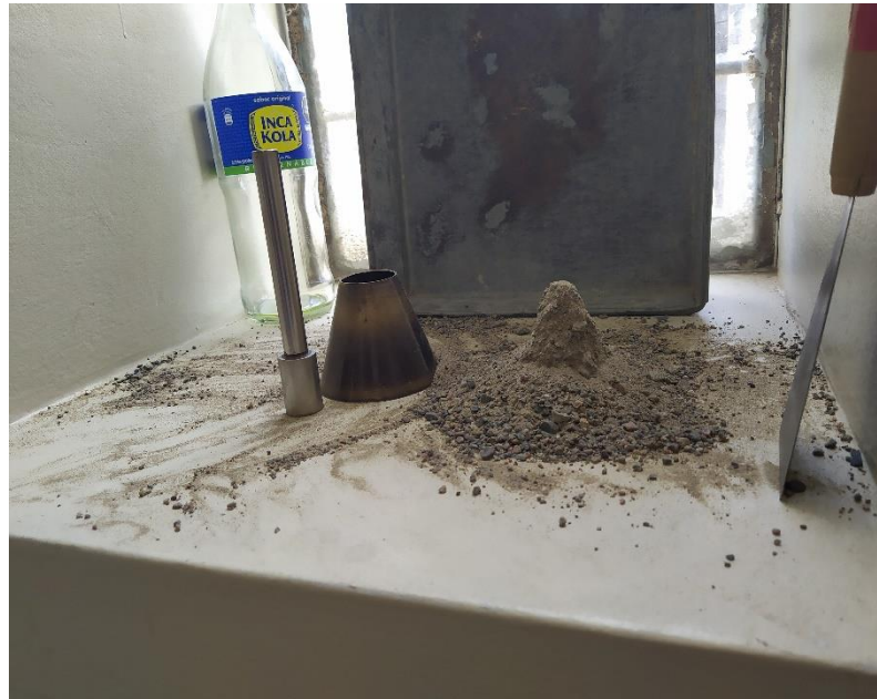
Figura 32. Ensayo de porcentaje de absorción del agregado fino
