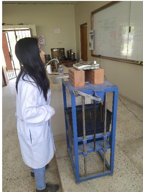
Figura 36. Ensayo de peso específico y absorción del agregado grueso
