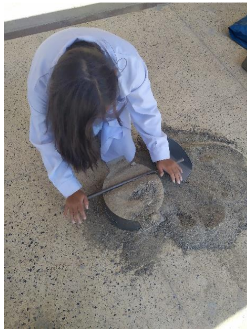
Figura 29. Ensayo de peso unitario suelto del agregado fino
