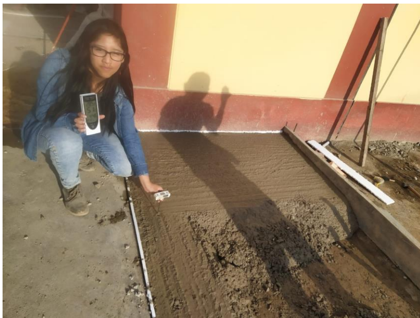
Figura 45. Humedad relativa y temperatura del ambiente, así como también la temperatura del concreto
