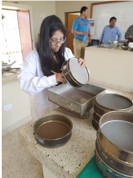
Figura 28. Ensayo de granulometría por método manual
