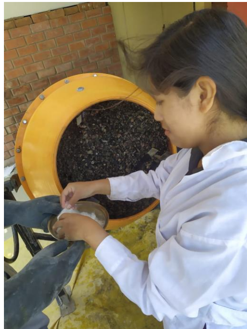
Figura 37. Agregando la fibra
