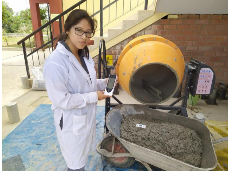
Figura 38. Controlando la humedad relativa y temperatura del ambiente, así como la temperatura del concreto
