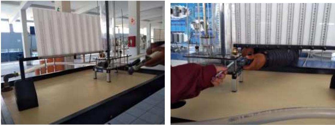
*FOTOGRAFÍA 4. Colocación de cada boquilla en el tanque para gasto constante del banco hidráulico*
