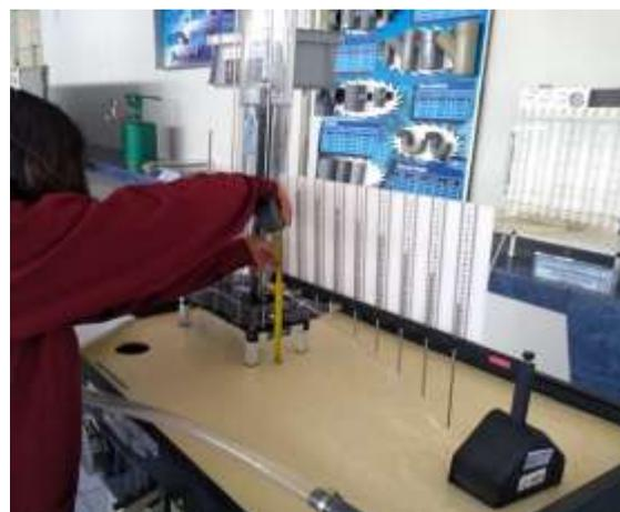
*FOTOGRAFÍA 9.* Toma de medida a partir del centro del orificio de la boquilla hasta el término del flujo del agua.
