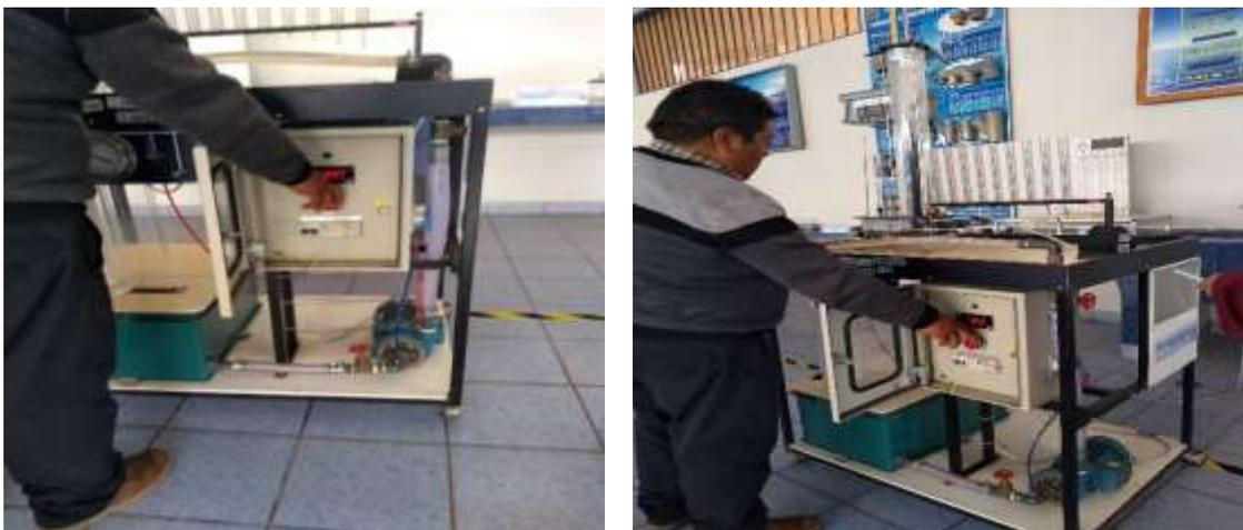
*FOTOGRAFÍA 6.* Ajuste de agujas del abaco con respecto a la trayectoria del flujo del agua
