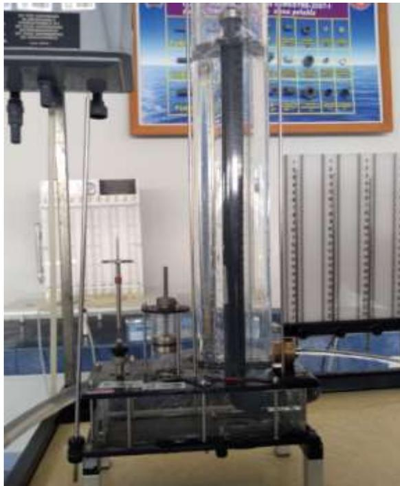
*FOTOGRAFÍA 3. Los conductos de entrada y derrame*
