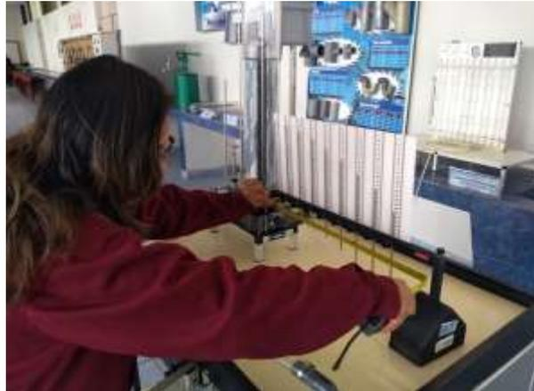
*FOTOGRAFÍA 10.* Toma de datos de la tabla con respecto a la trayectoria del flujo del agua
