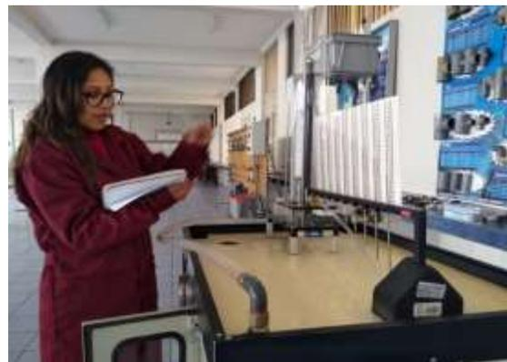
*FOTOGRAFÍA 8.* Toma de medida a partir de la base del banco hidráulico hasta el centro del orificio de cada boquilla
