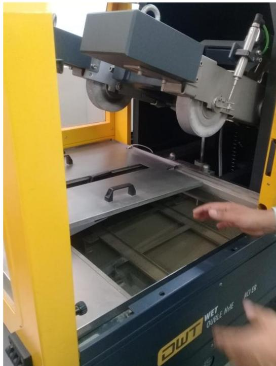
***Ilustración 11.- Equipo para el ensayo de la rueda cargada de Hamburgo***
