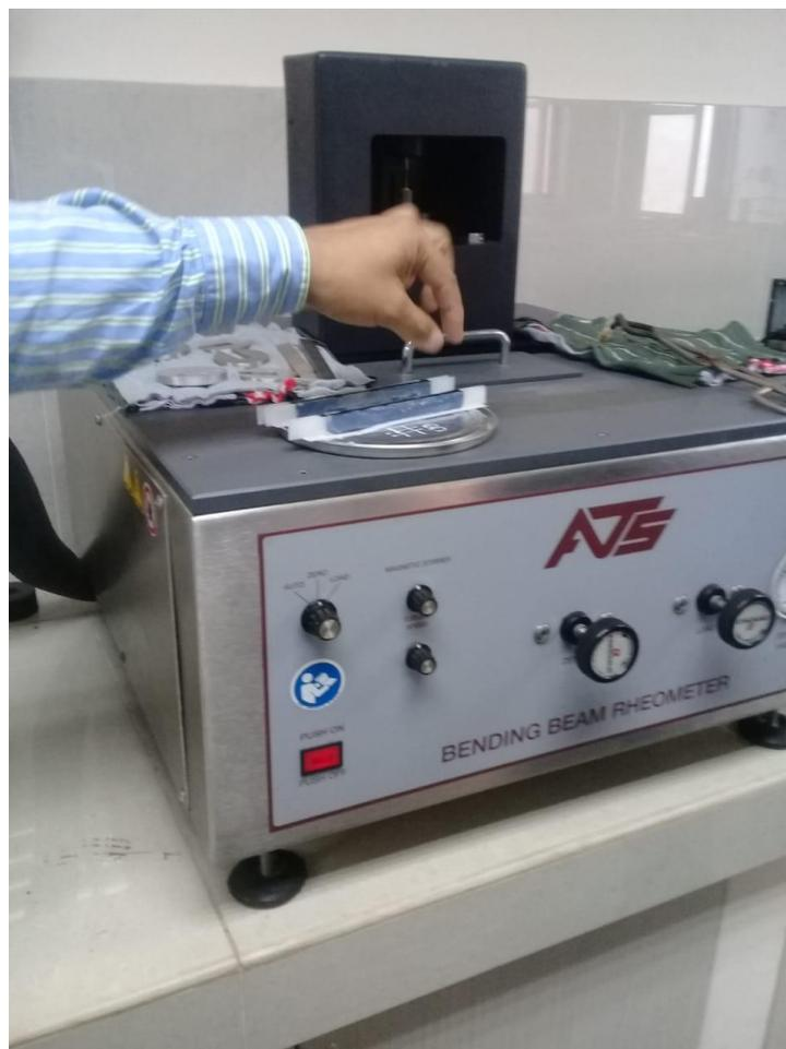
**Ilustración 7.- Ensayo de viga de a flexión (BBR)**
