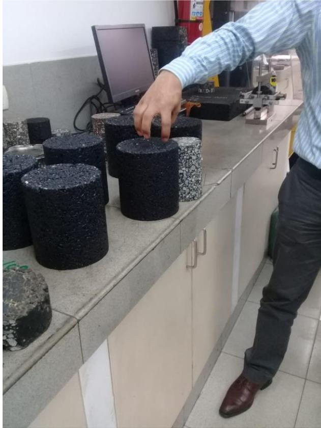
***Ilustración 10.- Testigos de Mezcla asfáltica***
