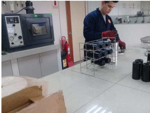
**Ilustración 6.- Ensayo de Horno de película delgada Rotacional (RTFO)**
