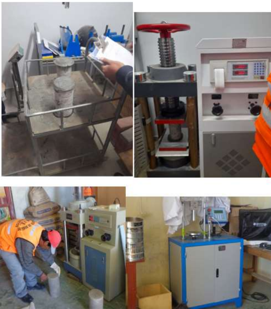
Gráfico 23: Ensayo a la compresión
