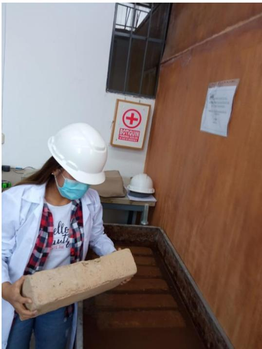
*Figura 9.* Colocado del adobe en la tina de acero para el ensayo de absorción.
