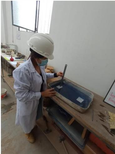
Fotografía 27. Para el ensayo de succión, se coloca en una bandeja agua y unos soportes pequeños, encima de los soportes el agua debe pasar 3mm.
