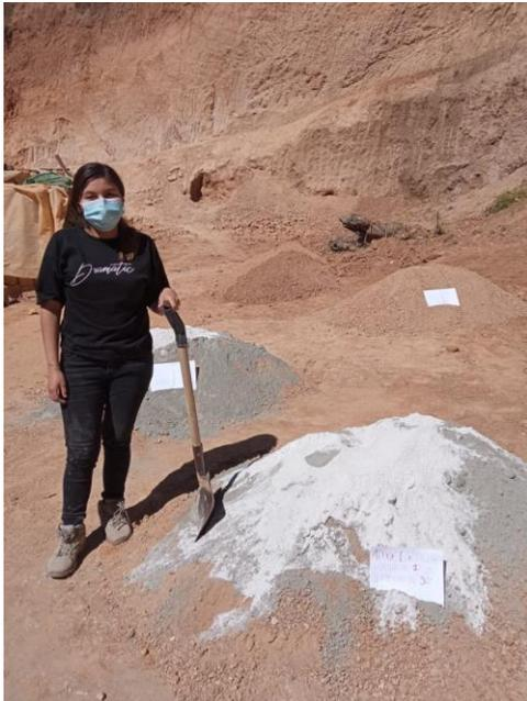
Fotografía 7. Se coloca en otro grupo cal al 1.5% y cemento al 4% y el último grupo con cal al 2% y cemento al 5% y se prosigue a mezclar los materiales.
