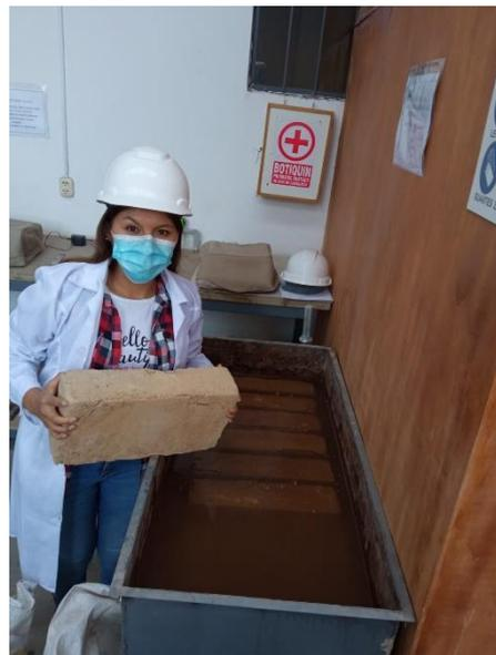
Fotografía 30. Posteriormente, para el ensayo de absorción se colocan las unidades de adobe a la tina de acero.
