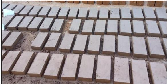
Fotografía 18. Se realiza el curado por 7 días consecutivos de los adobes estabilizados con cal y cemento en las diferentes dosificaciones.
