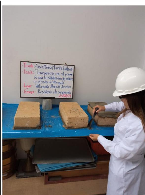
Figura 3. Nivelado del adobe para colocar en la prensa.
