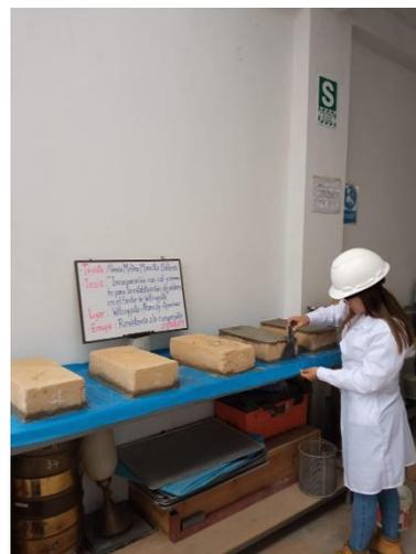
Fotografía 24. Se nivelaron los especímenes de adobe con una mezcla de yeso y cemento para que se coloquen en la prensa.
