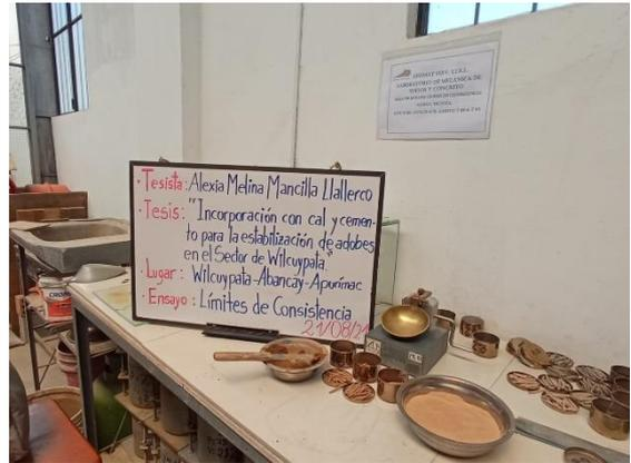
Fotografía 22. Realizando los ensayos para los límites de Consistencia.
