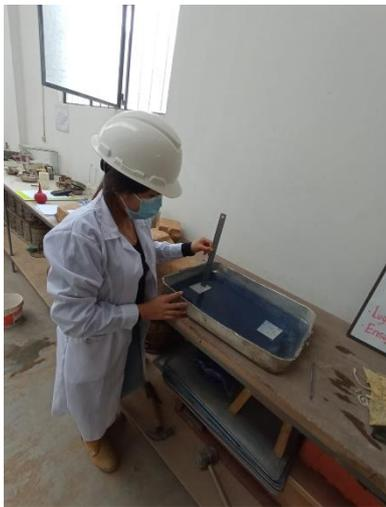
Figura 6. Colocado de los soportes en la bandeja y llenado de agua 3mm.
