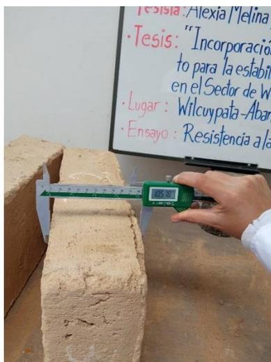
Fotografía 23. Se midieron las unidades de adobe con vernier y regla metálica, para así sacar sus dimensiones promedio.
