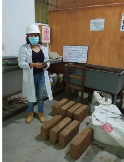
Fotografía 32. Pasadas las 24 horas se observa que los adobes estabilizados con cal al 1% y cemento al 3%, también la cal al 1.5% y cemento al 4% salen intactas.
