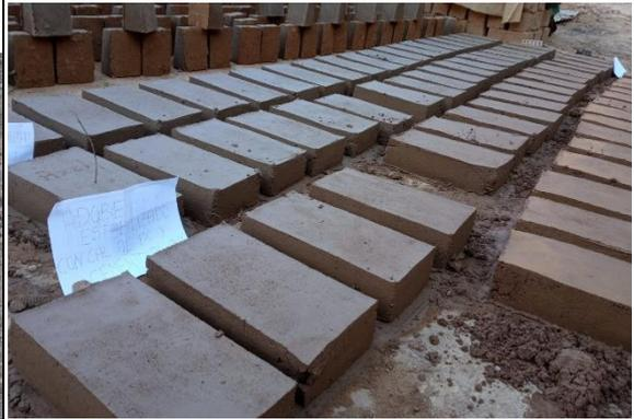
Fotografía 14. Obtención del adobe estabilizado con cal al 1% y cemento al 3%.
