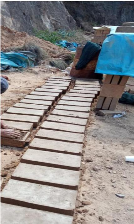
Fotografía 15. Obtención del adobe estabilizado con cal al 1.5% y cemento al 4%.
