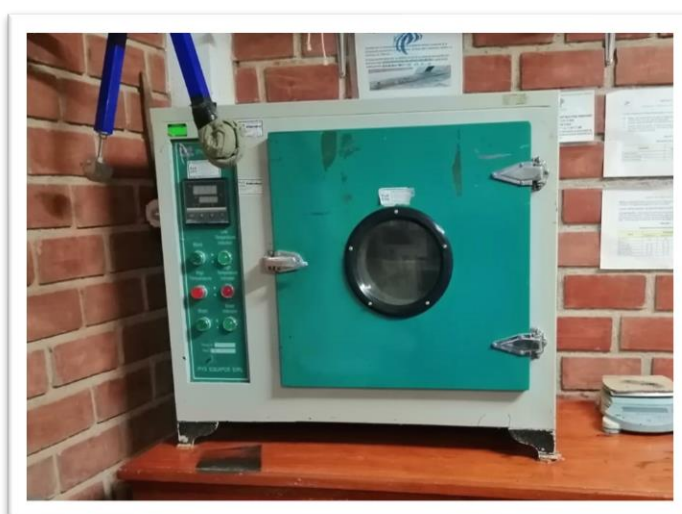
Figura 7: Horno para secado de muestra
