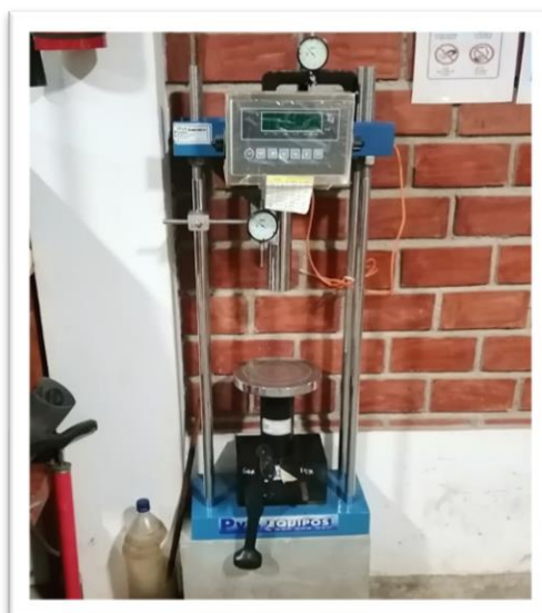
Figura 9: Equipo para ensayo de CBR
