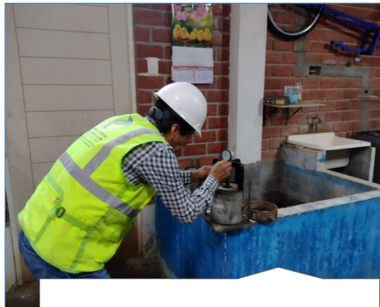
Fotografía N° 26: Preparacion de muestra para la inmersión
