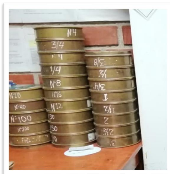
Figura 6: Tamices para ensayo de granulometría
