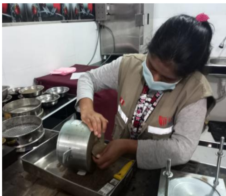
Foto N° 12: Sacando la muestra compactada después de los golpes
