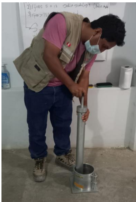
Foto N° 11: Se hace los 56 golpes y 12 golpes por cada 5 capas
