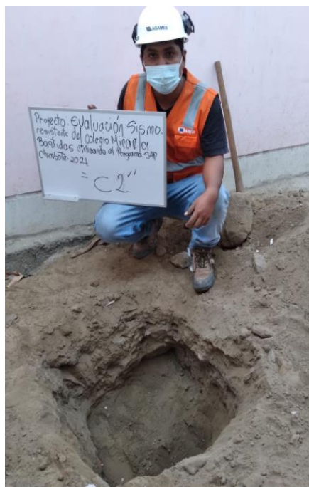
Foto N° 02: Excavación de la calicata C-2
