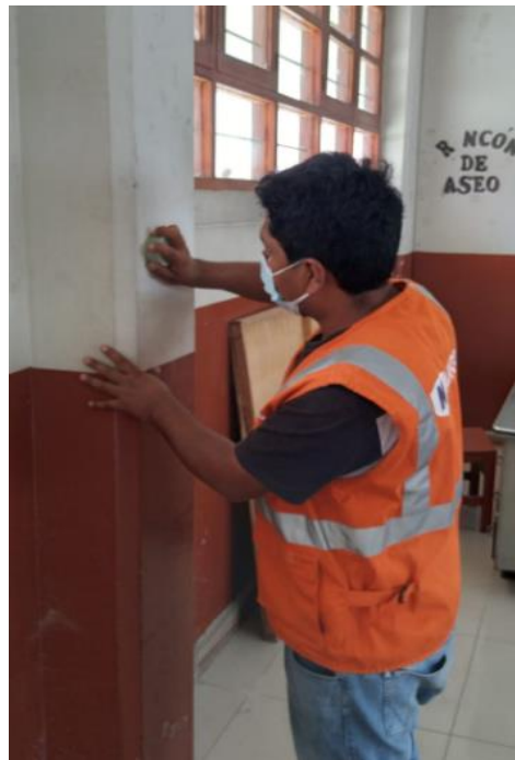
Foto N° 05: Lijado de la columna para el ensayo del esclerómetro
