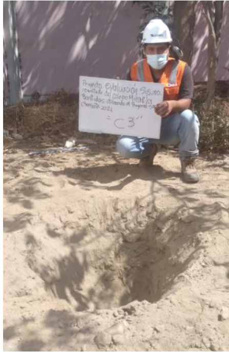
Foto N° 03: Excavación de la calicata C-3
