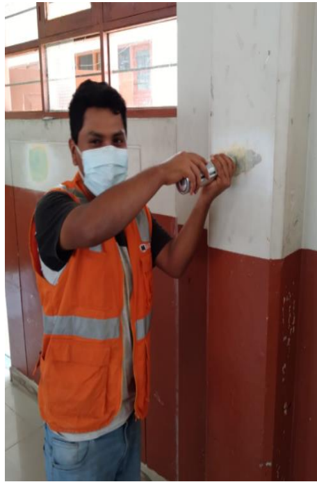
Foto N° 06: Utilización del esclerómetro en la COLUMNA
