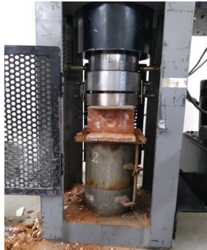
FOTOGRAFIA 21 y 22. Ensayo de compresión del ladrillo con la incorporación del 10% y 15% de aserrín.
