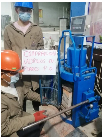
FOTOGRAFIA 39 y 40. Introducción de las pilas de ladrillos a la maquina compresora para el ensayo.
