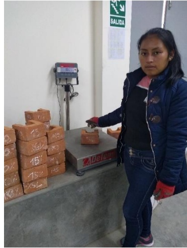
FOTOGRAFIA 25 y 26. Pesado de los ladrillos patrón y con la incorporación de 5% de aserrín respectivamente.
