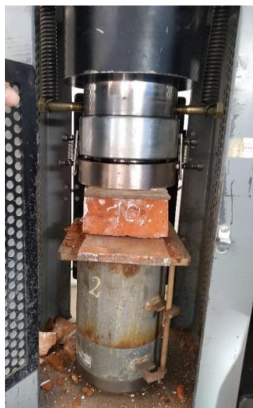
Figura 8 . Fractura de las medias unidades de ladrillo con la dosificación del 10% de aserrín.
