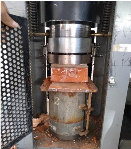
FOTOGRAFIA 21 y 22. Ensayo de compresión del ladrillo con la incorporación del 10% y 15% de aserrín.
