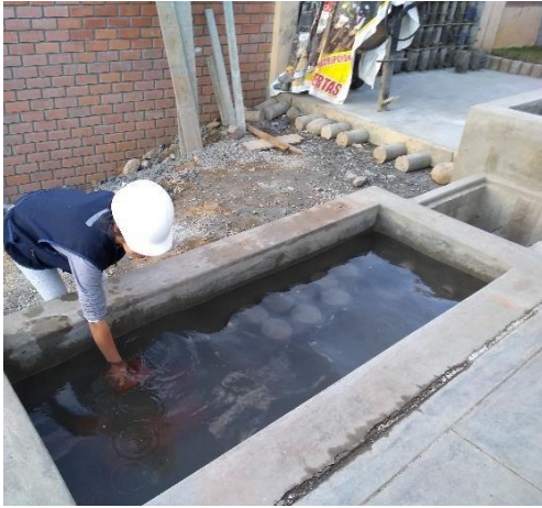
FOTOGRAFIA 31 y 32. Extracción de los ladrillos después de 24h.
