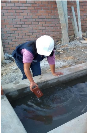
Figura 10. Introducción de los especímenes al agua.
