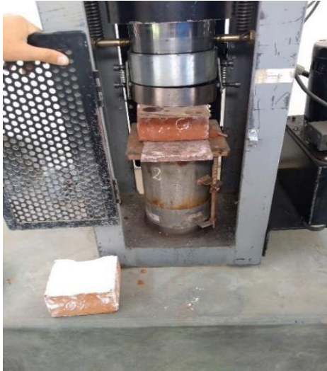
FOTOGRAFIA 19 y 20. Ensayo de compresión del ladrillo patrón e incorporación del 5% de aserrín.
