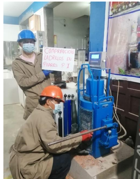
FOTOGRAFIA 39 y 40. Introducción de las pilas de ladrillos a la maquina compresora para el ensayo.
