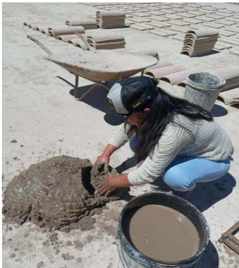
FOTOGRAFIA 9 y 10. Elaboración de ladrillos con la incorporación de aserrín
