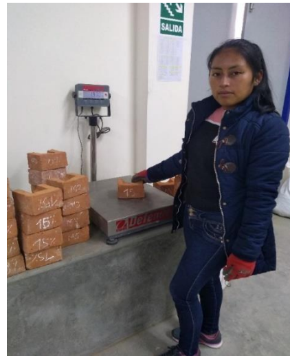
FOTOGRAFIA 27 y 28. Pesado de los ladrillos con la incorporación de 10% y 15% de aserrín respectivamente.
