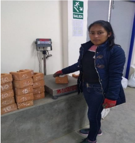
FOTOGRAFIA 25 y 26. Pesado de los ladrillos patrón y con la incorporación de 5% de aserrín respectivamente.
