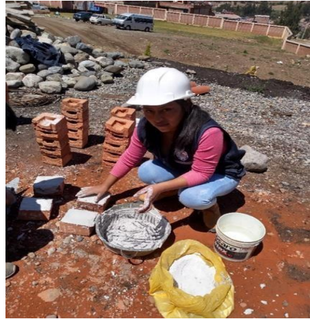
FOTOGRAFIA 13 y14. Corte por la mitad de los ladrillos y recubrimiento con yeso
