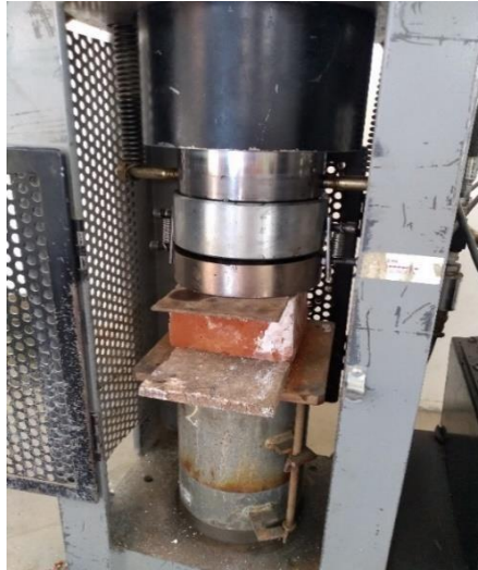
FOTOGRAFIA 19 y 20. Ensayo de compresión del ladrillo patrón e incorporación del 5% de aserrín.
