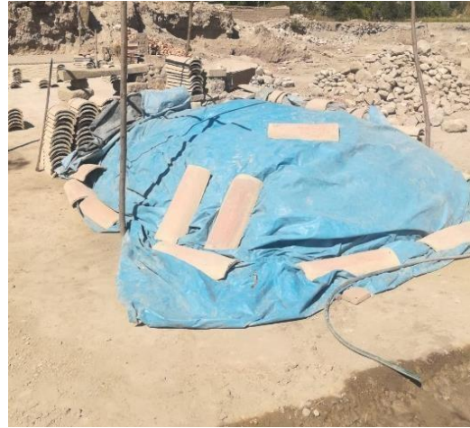
FOTOGRAFIA 7 y 8. Proceso de maduración de la mezcla durante 24h.
