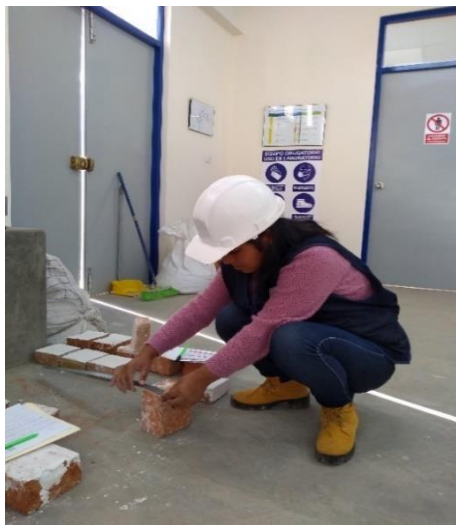
FOTOGRAFIA 15 y16. realizando medición de la altura y ancho del ladrillo.
