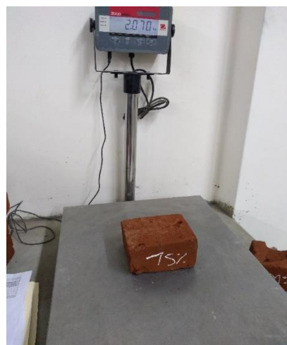
FOTOGRAFIA 35 y 36. Pesado del ladrillo con la dosificación de 10% y 15% de aserrín respectivamente, pasadas las 24h en el agua.
