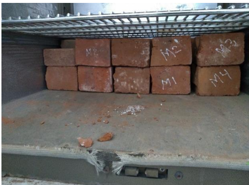
FOTOGRAFIA 23 y 24. Introducción y retiro de los ladrillos del horno para el ensayo de absorción.
