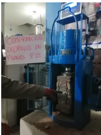
FOTOGRAFIA 41 y 42. Rotura de las pilas con la incorporación de aserrín
