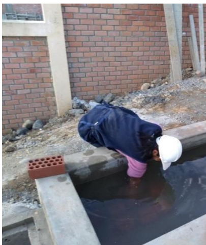
FOTOGRAFIA 29 y 30. Introducción de los ladrillos al agua por 24h.
