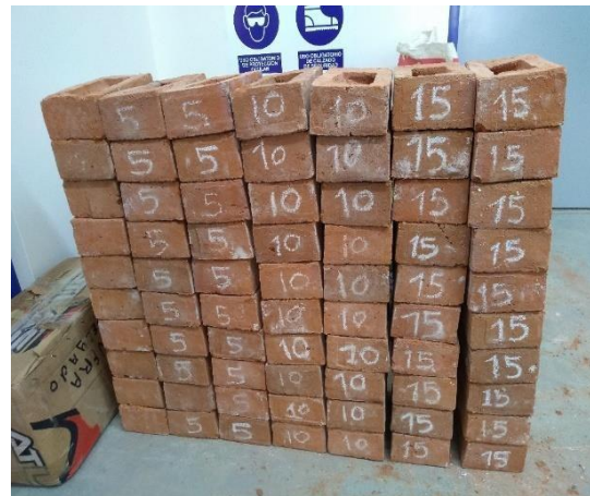
FOTOGRAFIA 9 y 10. Elaboración de ladrillos con la incorporación de aserrín
