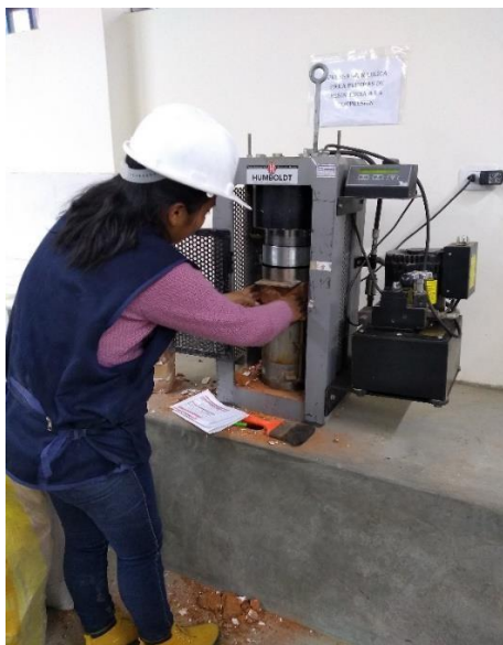
FOTOGRAFIA 17 y 18. Colación del ladrillo a la compresora.
