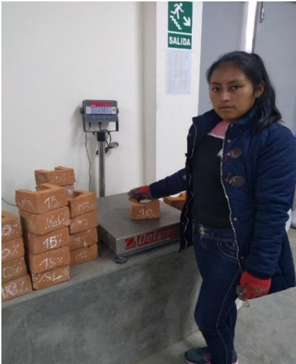
FOTOGRAFIA 27 y 28. Pesado de los ladrillos con la incorporación de 10% y 15% de aserrín respectivamente.
