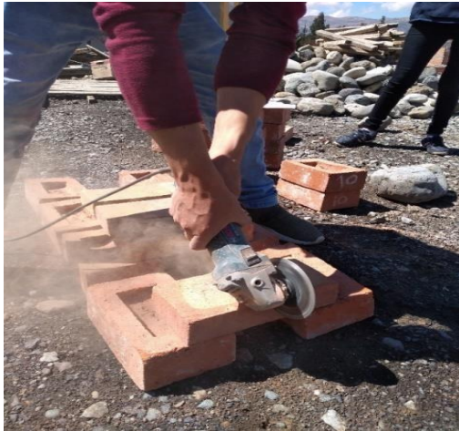
FOTOGRAFIA 13 y14. Corte por la mitad de los ladrillos y recubrimiento con yeso
