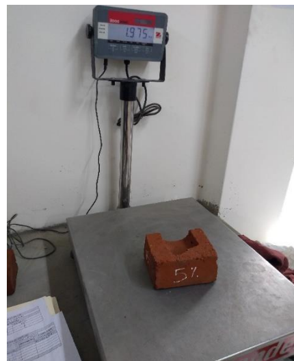
FOTOGRAFIA 33 y 34. Pesado del ladrillo patrón y la dosificación de 5% de aserrín respectivamente, pasadas las 24h en el agua.
