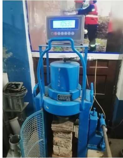
Figura 14. Fractura de la pila de ladrillo.
