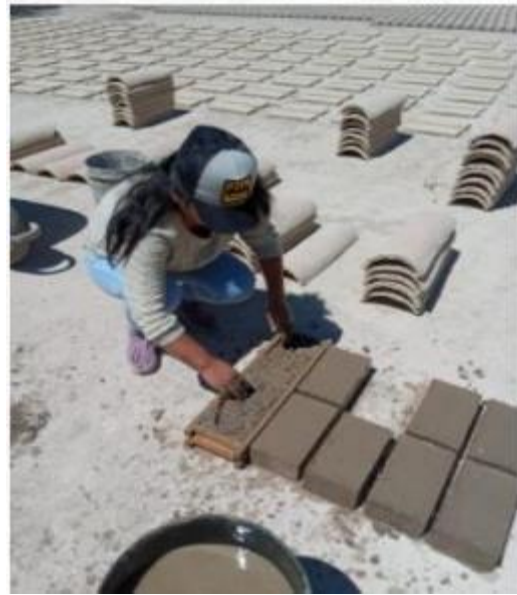
Figura 4. elaboración de ladrillos artesanales con la incorporación de aserrín.
