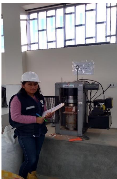
Figura 7. Introducción del ladrillo a la compresora.
