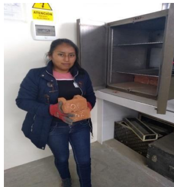
FOTOGRAFIA 23 y 24. Introducción y retiro de los ladrillos del horno para el ensayo de absorción.
