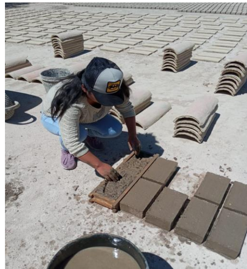
FOTOGRAFIA 9 y 10. Elaboración de ladrillos con la incorporación de aserrín
