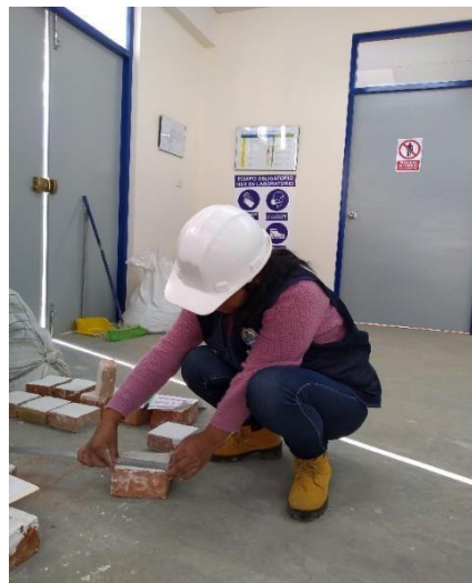
FOTOGRAFIA 15 y16. realizando medición de la altura y ancho del ladrillo.
