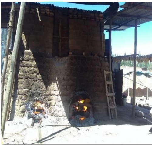
FOTOGRAFIA 11 y 12. cocción y retiro del horno de los ladrillos artesanales.
