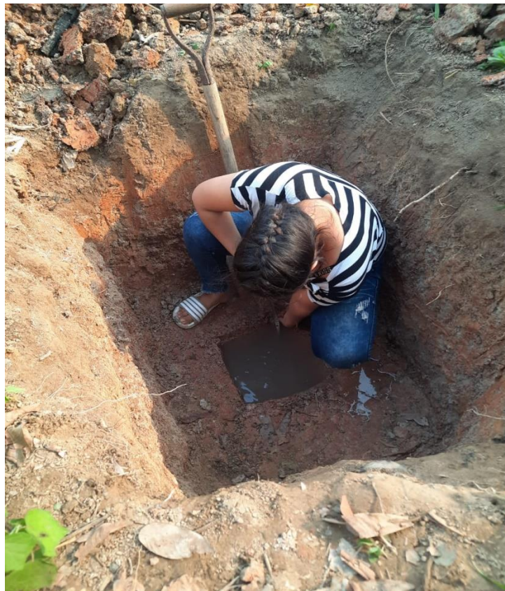
Medición del agua para el tes de percolación+n
