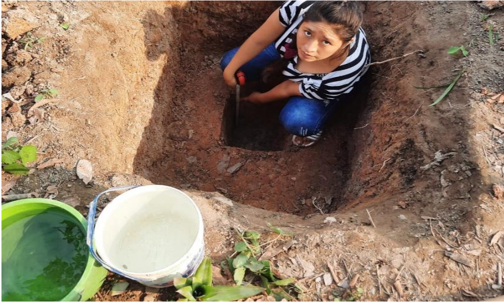
Medición de la profundidad para el tes de percolación
