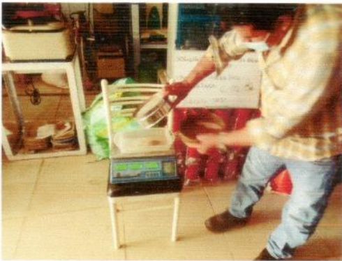
Ensayos de Clasificación de las Muestras de la Calicata N°01 en Laboratorio "Geotecnica"
