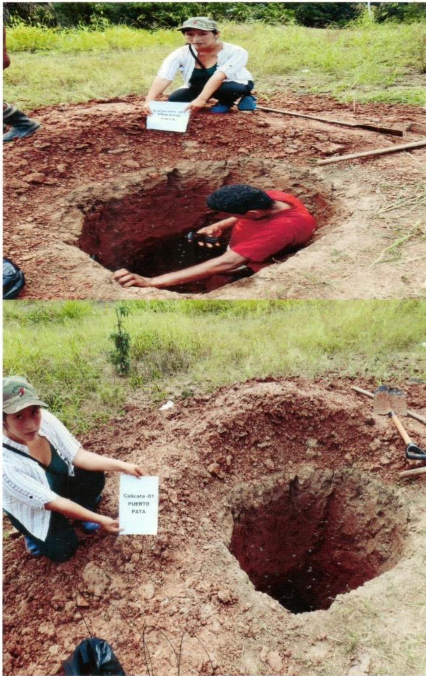
EXPLORACION Y TOMA DE MUESTRA DE LOS ESTRATOS EN LA CALICATA N°01
