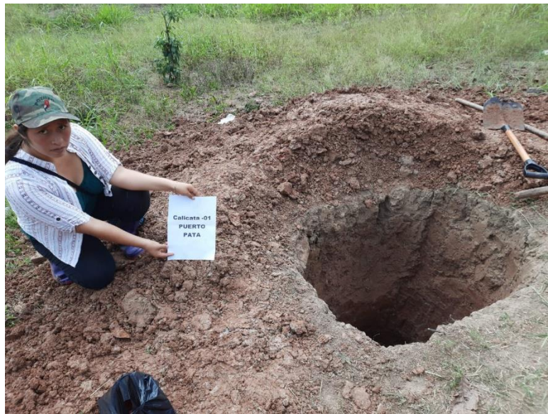
Se muestra toma de muestra de la calicata-1 en el caserío de puerto Pata
