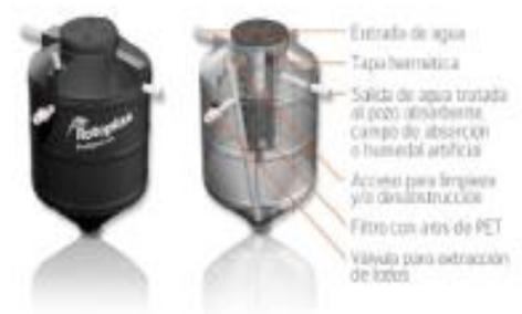
**PLANTA BIODIGESTOR - POZO DE LODOS Y POZO PERCOLADOR**
