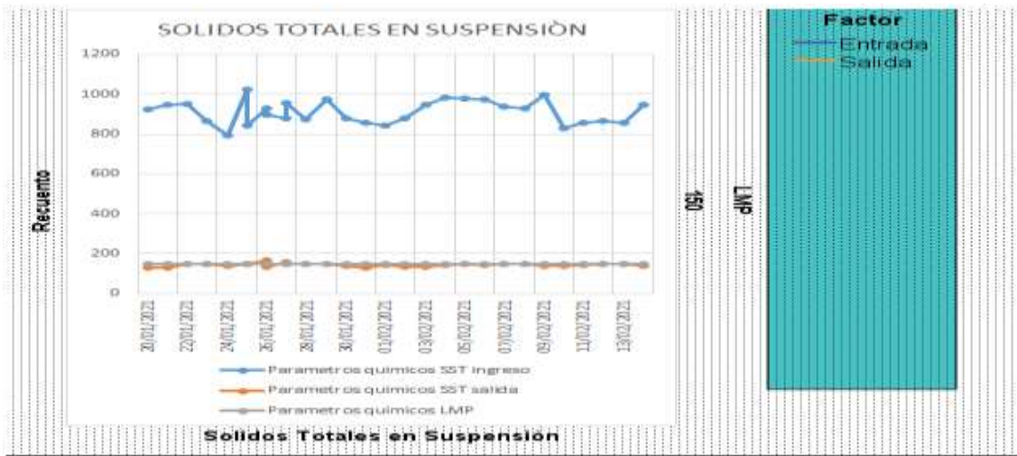
Figura 20. Evaluación del efecto del humedal artificial Waylla Ichu ( Calamagrostis rígida ); en el tratamiento (SST) de aguas servidas del barrio de Santa Ana – Huancavelica los parámetros físicos
