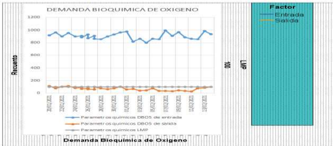
Figura 18. Evaluación del efecto del humedal artificial Waylla Ichu ( Calamagrostis rígida ); en el tratamiento (DBO) de aguas servidas del barrio de Santa Ana – Huancavelica los parámetros físicos
