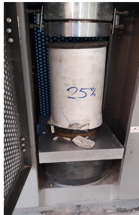
Figura 8 Rotura de briqueita al 25% de fibra de vidrio en la mezcla
