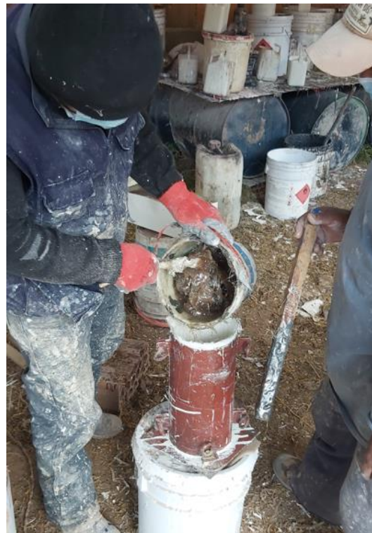
Colocación de la mezcla de resina con fibra de vidrio en la briquetera para la fabricación de las muestras
