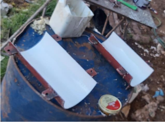
Colocación de desmoldante en las briqueteras para la fabricación de las muestras
