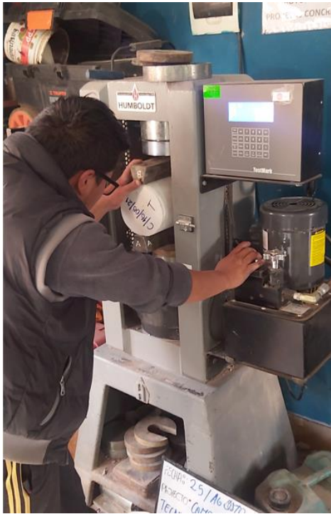
Colocación en forma horizontal de las muestras para el ensayo de resistencia a la tracción
