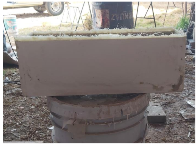
Fabricación de vigueta de medidas 15x15x45 cm
