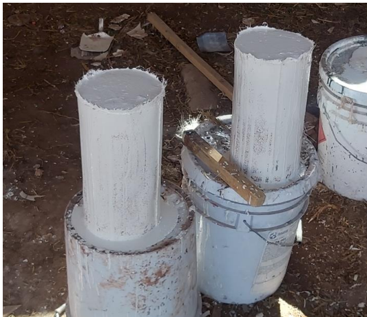
Obtención de las muestras cilíndricas de resina poliéster reforzado con fibra de vidrio
