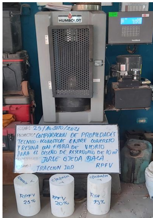
Inicio de ensayo de tracción de muestras cilíndricas fabricadas con RPFV
