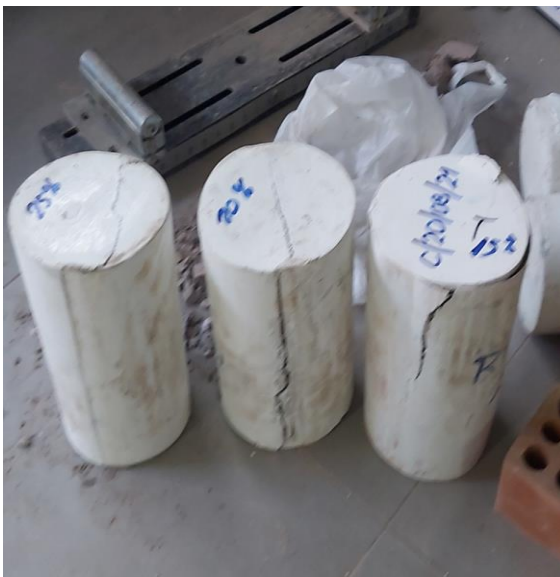
Colocación en forma horizontal de las muestras para el ensayo de resistencia a la tracción
