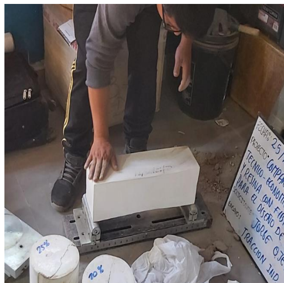
Preparación de los equipos y colocación vigueta para ser sometida al ensayo de resistencia a la flexión
