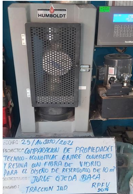
Ensayo de tracción de muestra cilíndrica al 20 % de RPFV en proceso
