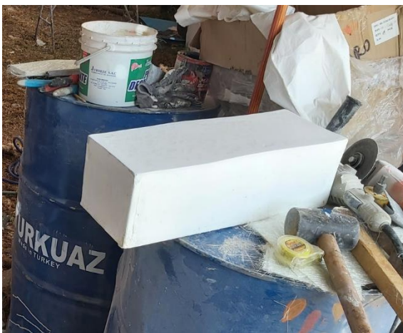
Vigueta fabricada con resina reforzada con fibra de vidrio
