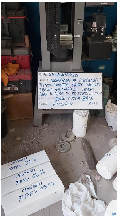
Figura 14 Preparación de viguetas para ser sometidas al ensayo de flexión
