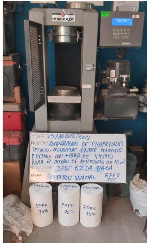
Inicio de ensayo de resistencia a la compresión de muestras cilíndricas fabricadas con RPFV
