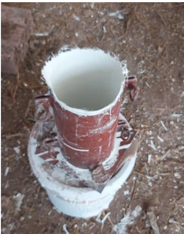
Briquetera lista para recibir la mezcla de resina poliéster reforzada con fibra de vidrio
