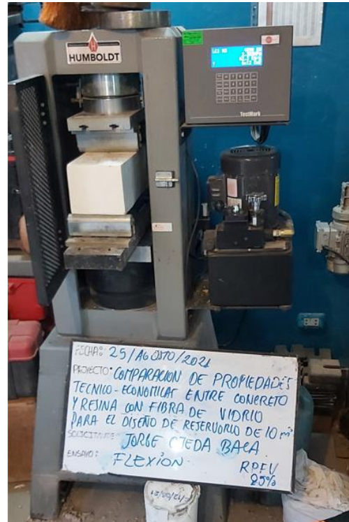
Ensayo de resistencia a la flexión de muestra cilíndrica al 25 % de RPFV en proceso
