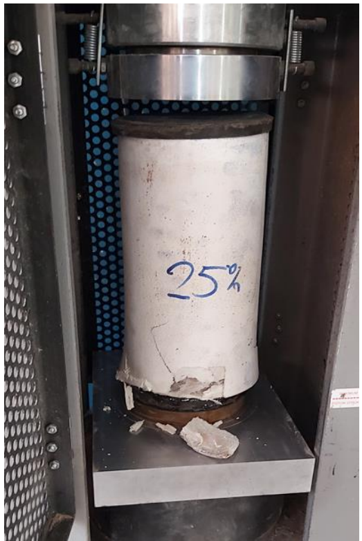
Falla de la muestra cilíndrica
