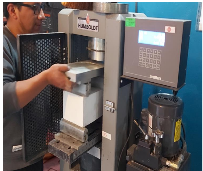
Figura 13 Colocación de vigueta para inicio del ensayo de resistencia a la flexión
