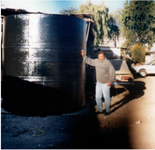
Tanque de almacenamiento circular fabricado en resina poliéster reforzado con fibra de vidrio
