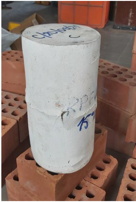
Resultado de cómo queda las muestras luego de ser sometidas al ensayo
