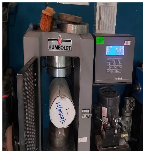
Figura 11 Rotura de muestra en el ensayo de tracción
