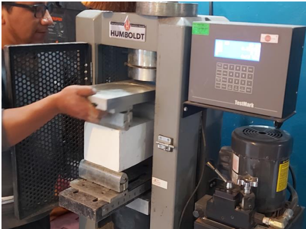
Vigueta colocada en posición para dar inicio al ensayo de resistencia a la flexión
