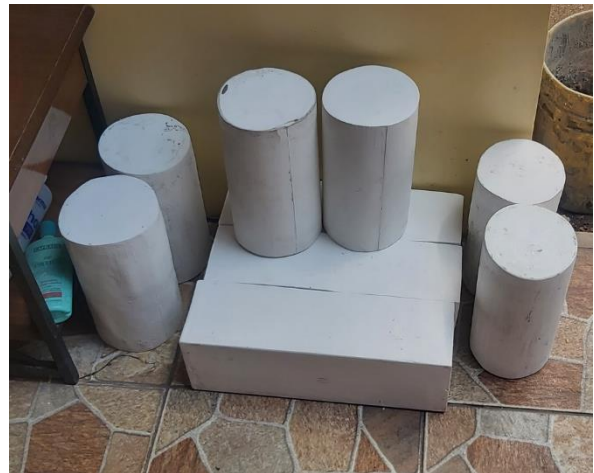
Fabricación de vigueta de medidas 15x15x45 cm
