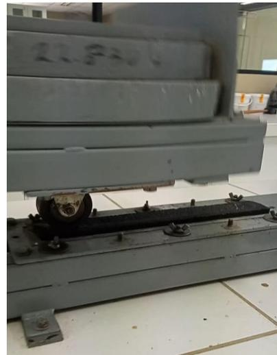
Figura 13. Prueba de rueda cargada
