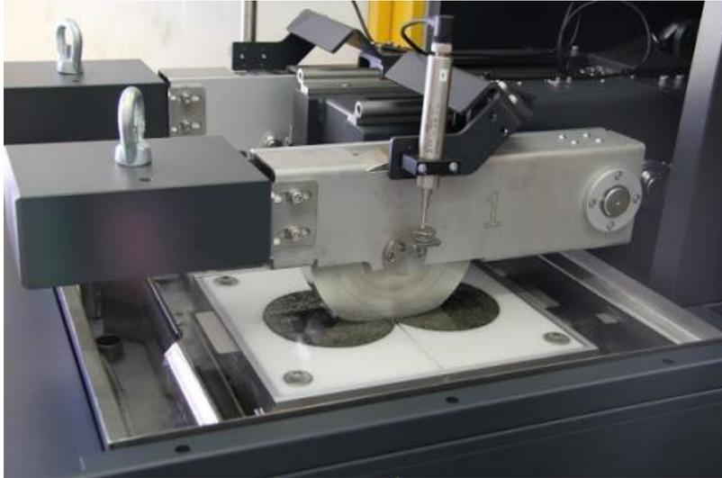
Figura 4. Ensayo de la rueda cargada
