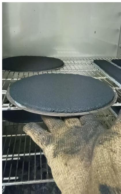
Figura 11. Muestra en máquina de abrasión
