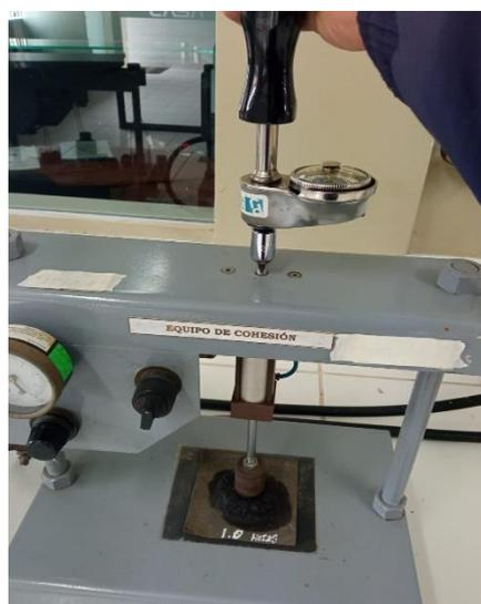
Figura 15. Muestras en el cohesiómetro
