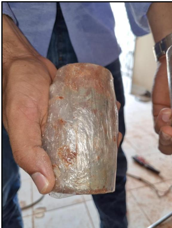
**Fotografía 6:** Extracción de la muestra para ensayo de compresión simple inconfiada.
