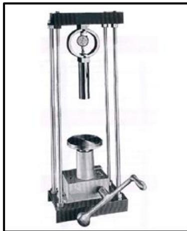
**Figura 2:** Aparato de Compresión Simple Inconfinada de Suelos Cohesivos
