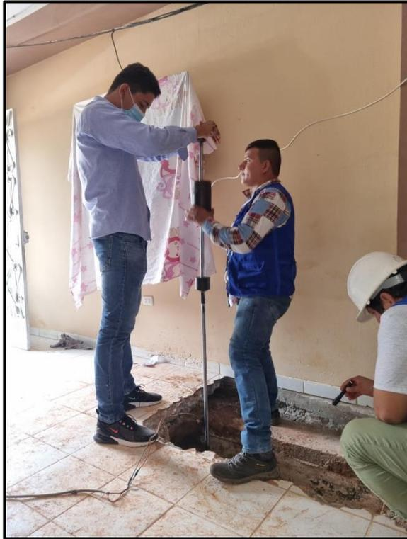
**Fotografía 5:** Aplicación de fuerza de 10kg en ensayo DPL.
