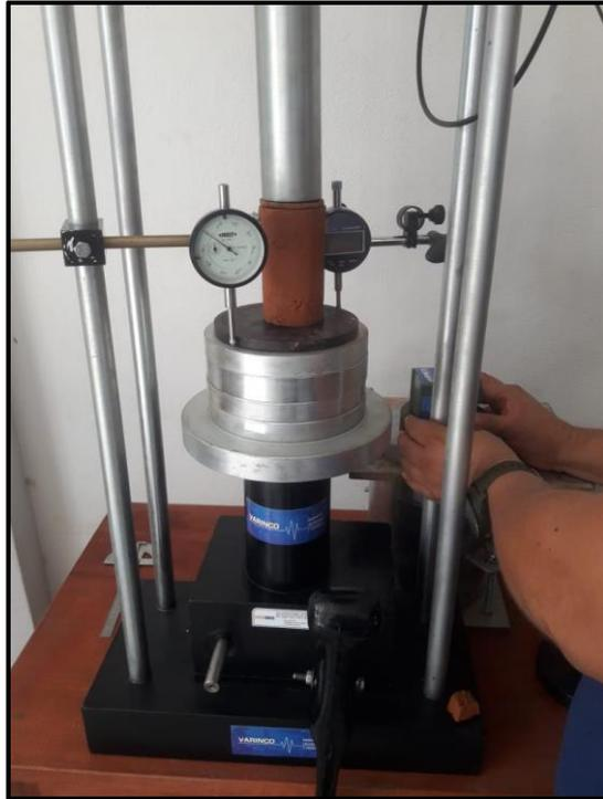
**Fotografía 11:** Aplicación de la fuerza con el equipo del ensayo de compresión simple inconfiada.
