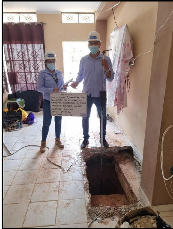
**Fotografía 3:** Ensayo DPL en uno de los puntos de exploración – ensayo in situ.
