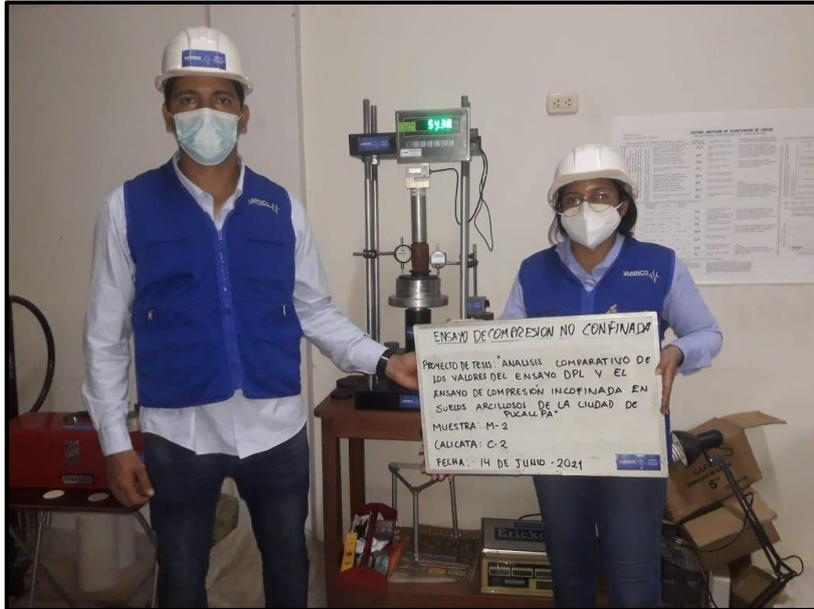
**Fotografía 7:** Ensayo de compresión simple inconfiada calicata C-2, Muestra M-2.
