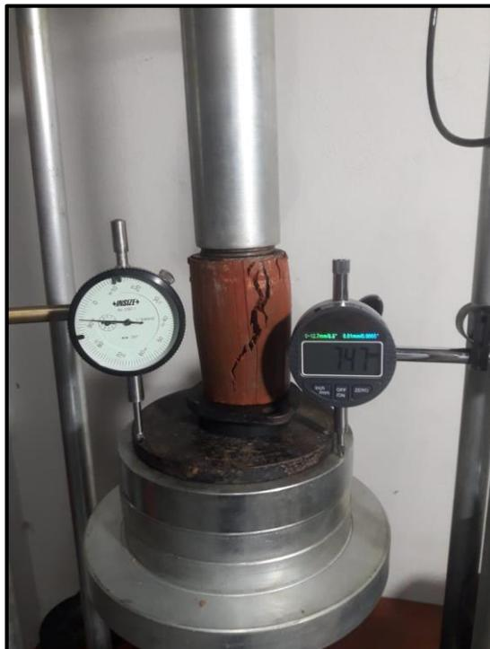
**Fotografía 12:** Deformación de la Muestra del ensayo de compresión simple inconfiada.
