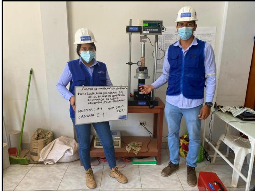
**Fotografía 9:** Ensayo de compresión simple inconfiada calicata C-1, Muestra M-1.
