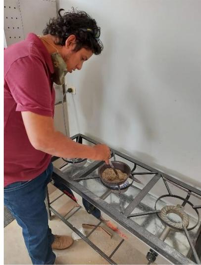
Cuarteo de agregados y ensayo para humedades de agregados.
