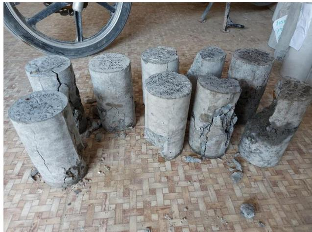
Fallas de las probetas.
