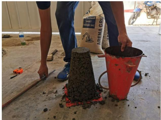
Slump de los diferentes diseños de mezclas patrón y con adiciones.
