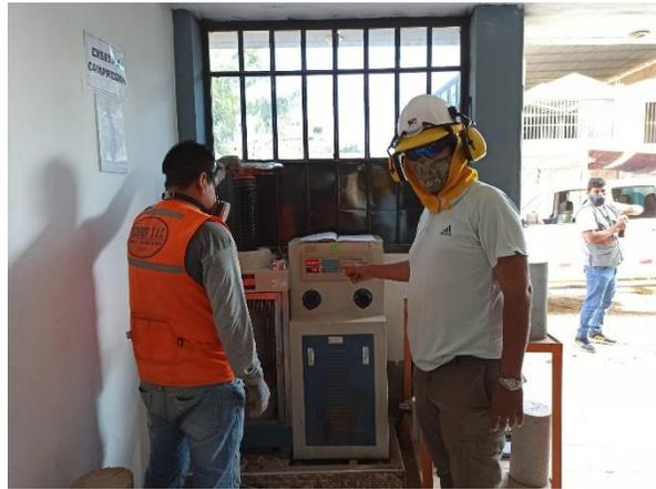
Toma de medidas de probetas, llenado de fichas de observaciones y ensayos de resistencia a la compresión de las probetas.
