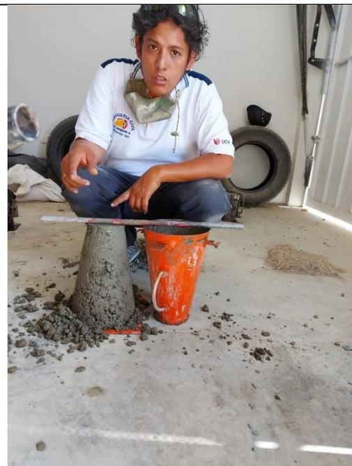
Llenado en cono de Abrams para determinar asentamiento del concreto.
