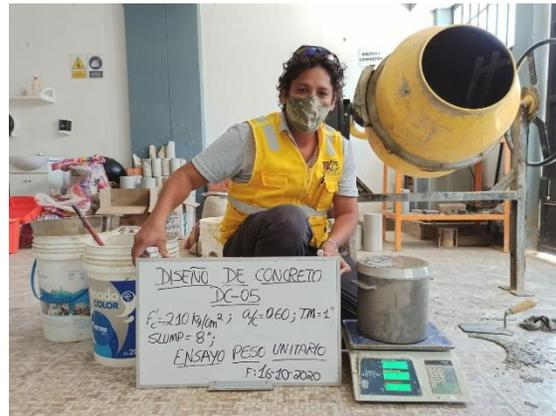
Ensayos de aire incorporado y peso unitario del concreto fresco
