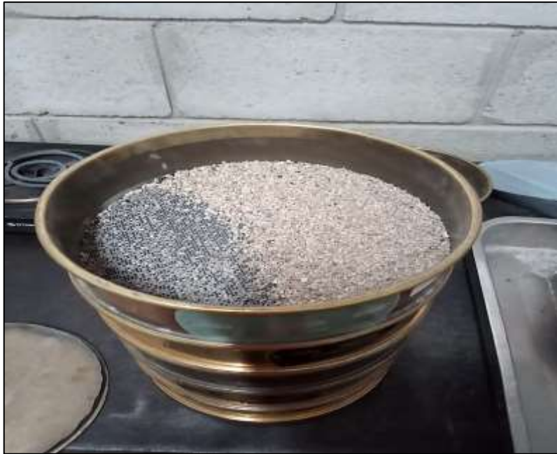
Fotografía n.º 01. Análisis granulométrico del agregado fino – Arena Solumbre.
