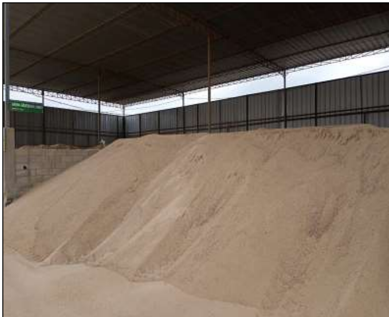
Fotografía n.º 02. Material proveniente de Cantera Solumbre - Arena gruesa.
