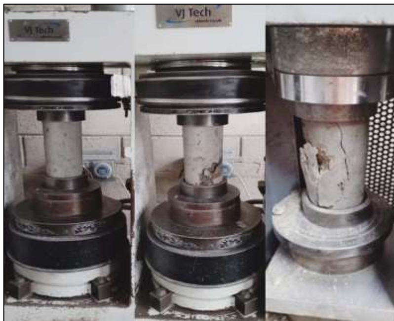
Fotografía n.º 16. Ensayo de resistencia a la compresión.
