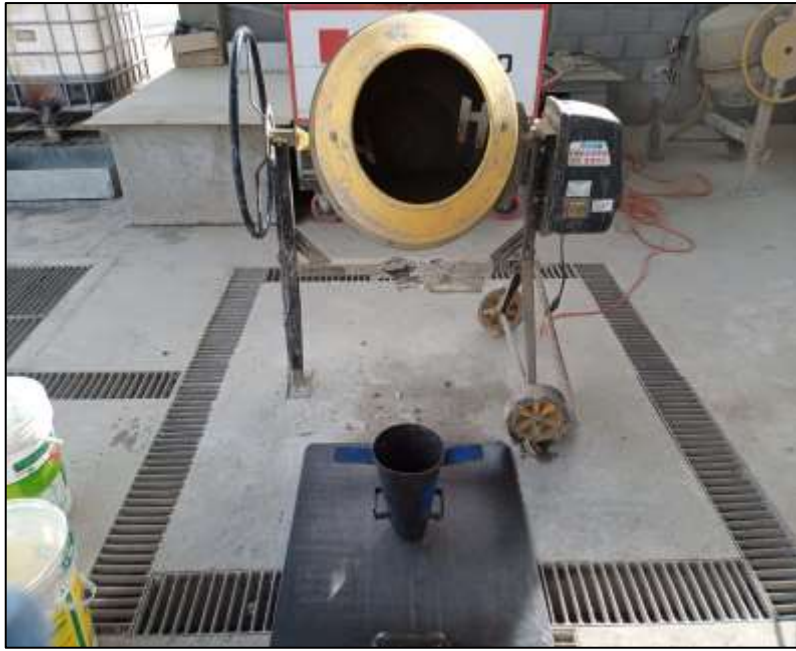
Fotografía n.º 09. Ensayo de asentamiento o fluidez con el cono invertido.
