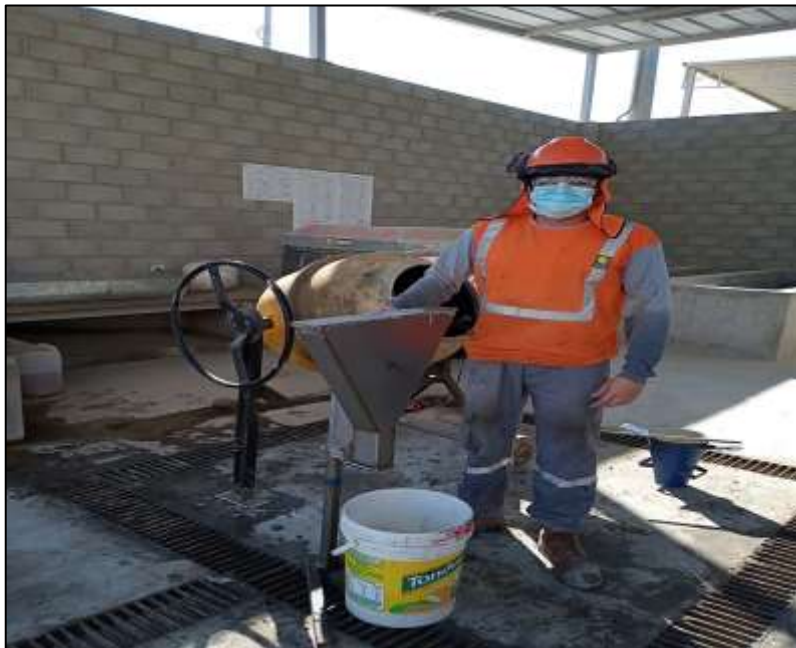
Fotografía n.º 12. Ensayo del embudo en "V".
