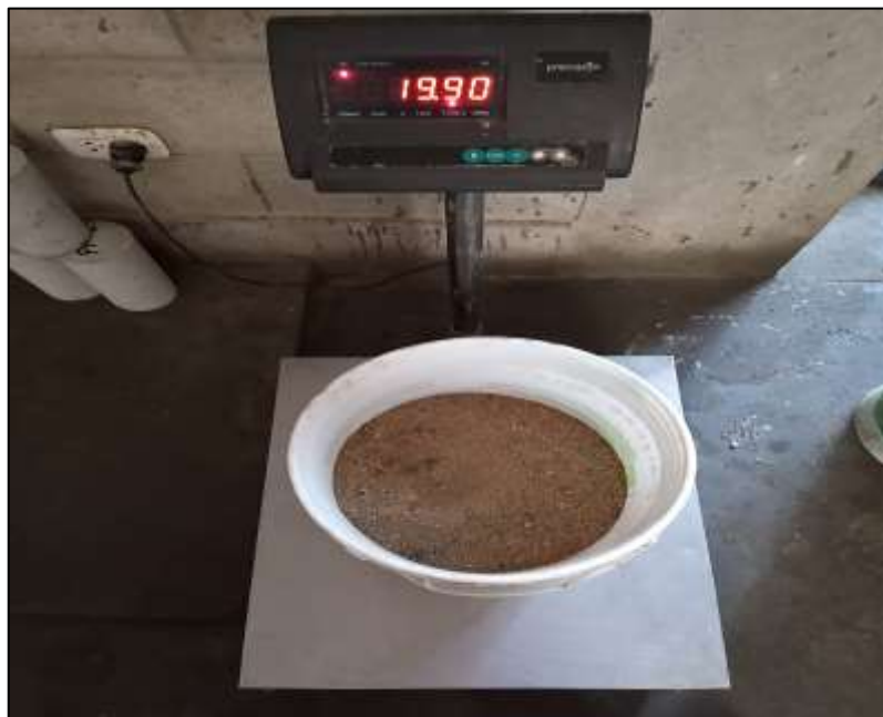
Fotografía n.º 06. Pesaje de la arena gruesa para elaboración de la mezcla (tanda de prueba 30 litros).
