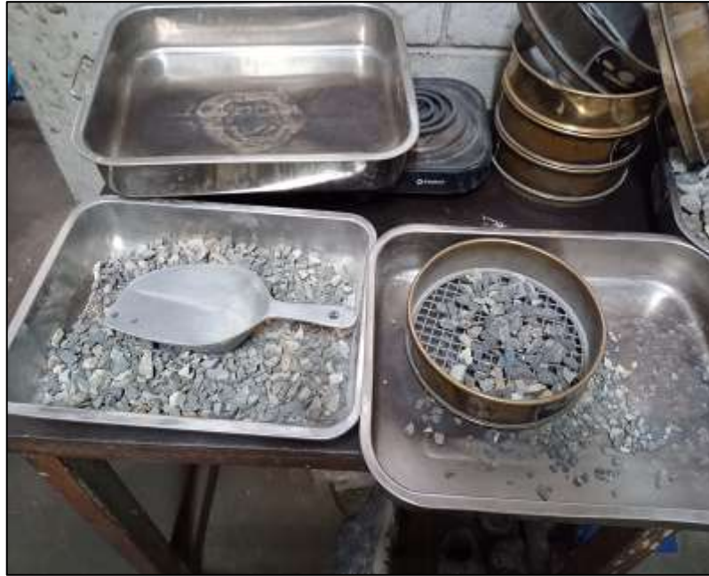
Fotografía n.º 03. Análisis granulométrico del agregado grueso – Piedra Huso 67.
