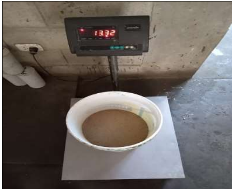
Fotografía n.º 05. Pesaje de la arena fina para elaboración de la mezcla (tanda de prueba 30 litros).
