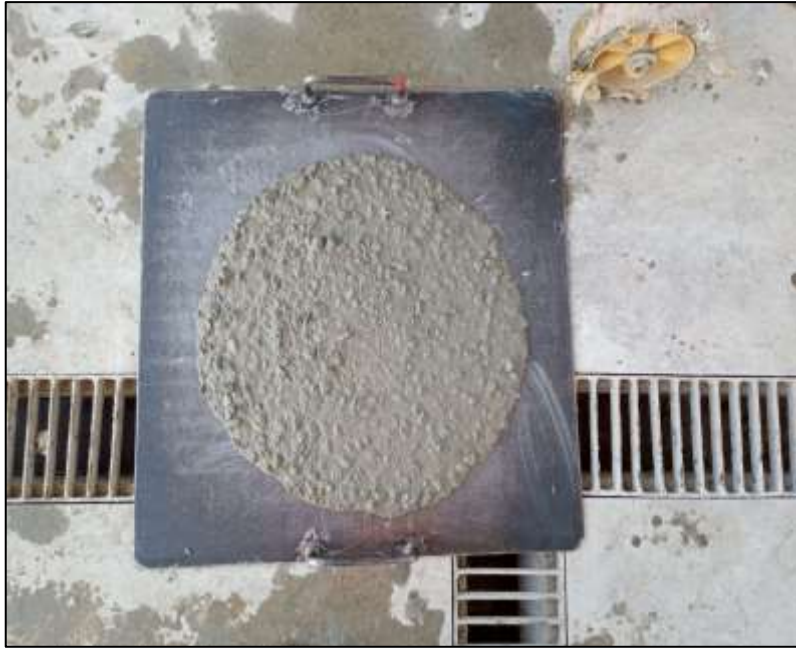
Fotografía n.º 11. Pérdida de fluidez de la mezcla.
