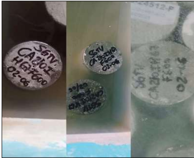
Fotografía n.º 15. Proceso de curado de las muestras cilíndricas.
