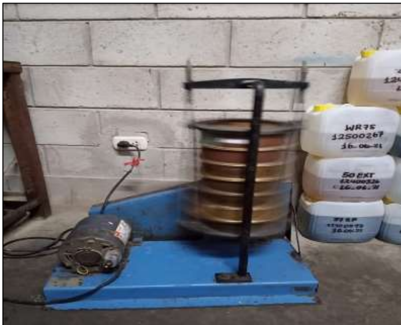
Fotografía n.º 02. Análisis granulométrico del agregado fino – Arena Congora.
