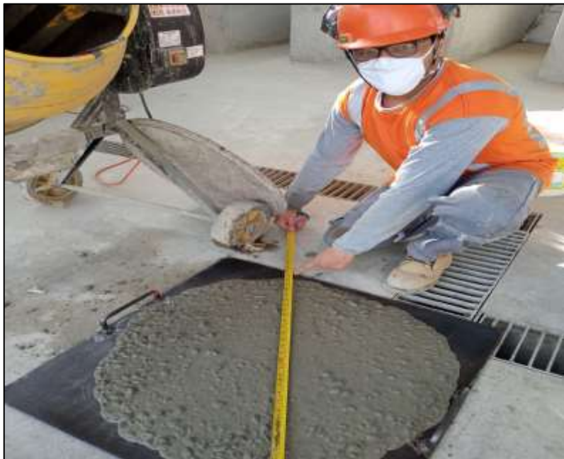
Fotografía n.º 10. Medición de la fluidez de la mezcla.
