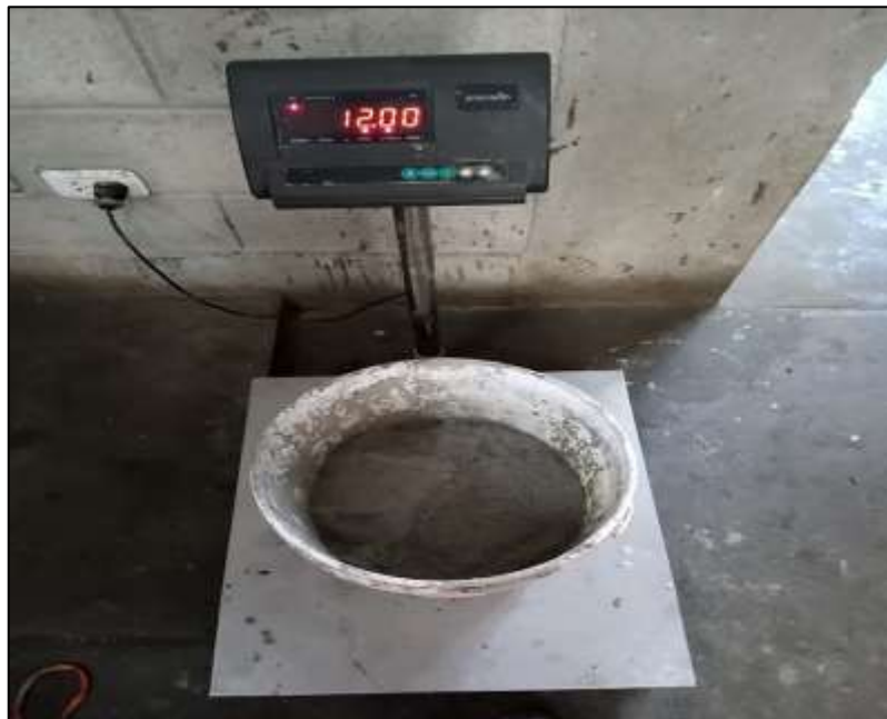
Fotografía n.º 04. Pesaje del material cemento para elaboración de la mezcla (tanda de prueba 30 litros).
