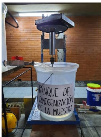
Figura 23. Tanque de Homogenización
