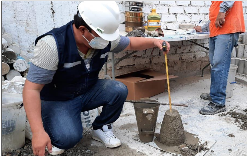
Figura 47. Ensayo de Asentamiento NTP 339.035.
