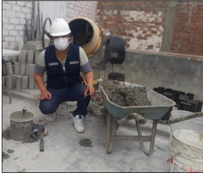
Figura 51. Ensayo de temperatura NTP 339.184.
