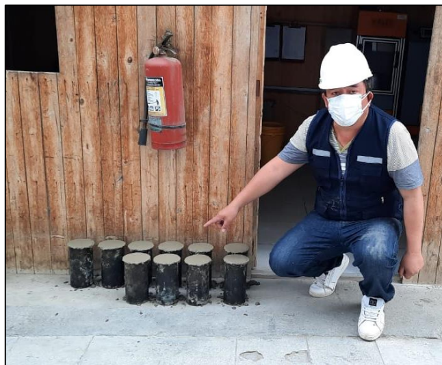
Figura 54. Probetas listas para fraguado.
