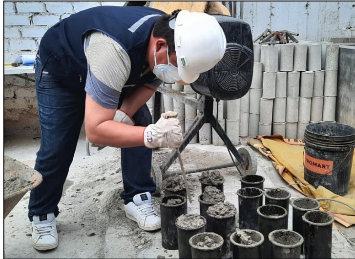
Figura 53. Elaboración de probetas Varillado NTP 339.183.
