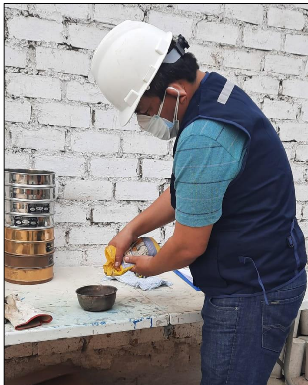
Figura 48. Dosificando Sikacem 1 Plastificante para el diseño de mezcla III.
