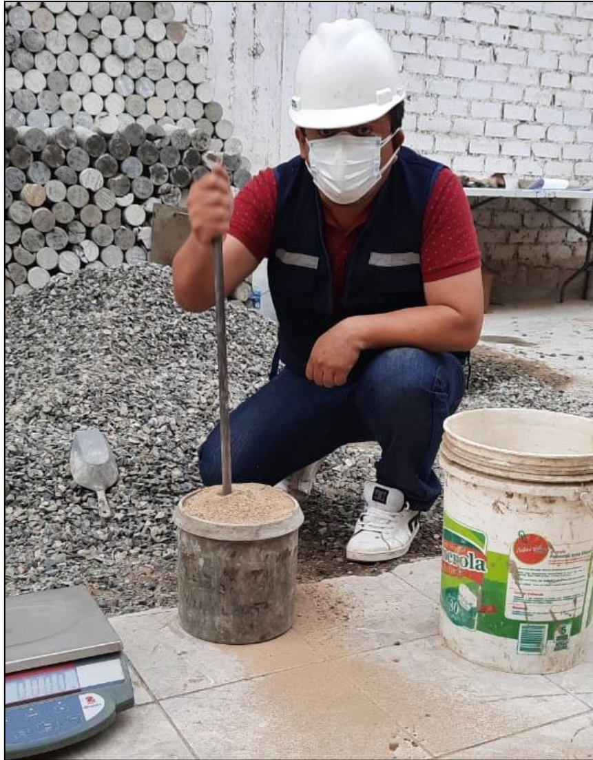
Figura 46. Ensayo de peso unitario compactado de agregado fino NTP 400.017.
