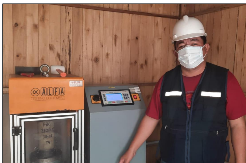
Figura 58. Ensayo de compresión NTP 339.034.
