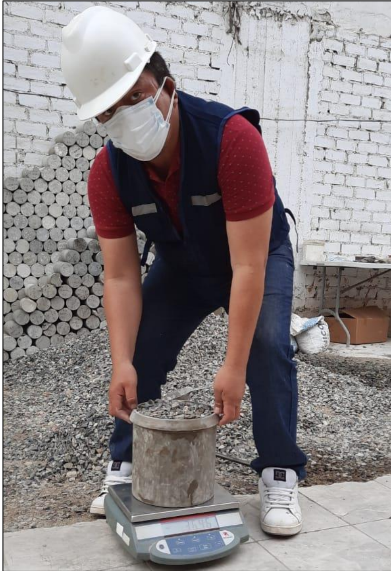
Figura 45. Ensayo de agregado grueso peso unitario suelto / compactado NTP 400.017.
