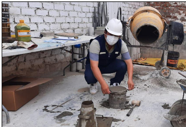
Figura 50. Ensayo de peso unitario NTP 339.046.
