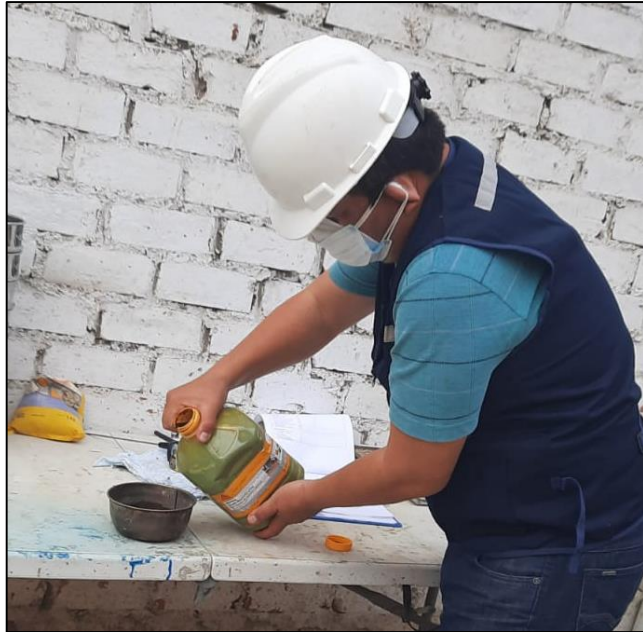
Figura 49. Dosificando con Sikacem Plastificante para diseño de mezcla I y II.
