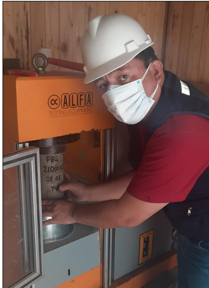
Figura 57. Preparación de probeta para ensayo a compresión NTP 339.034.
