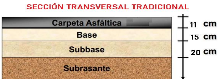
Figura 32. Sección típica de una calzada tradicional.
