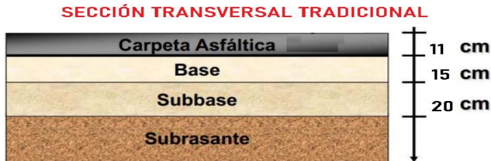
Fig. 32. Sección típica de una calzada tradicional
