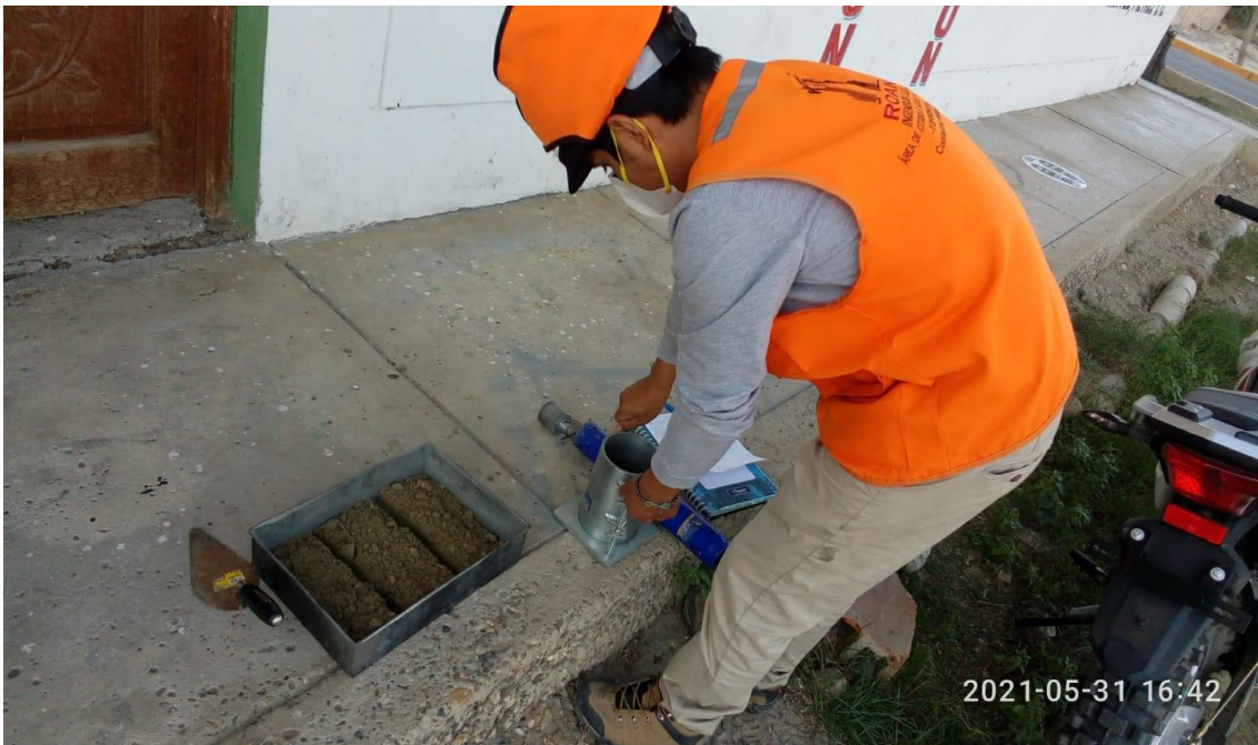
Figura 8: Ensayo de próctor modificado (ASTM D1557 / NTP 339.141)
