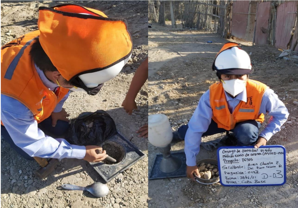
Figura 29. Ensayo de Densidad IN SITU método cono de Arena en la capa con neumáticos.
