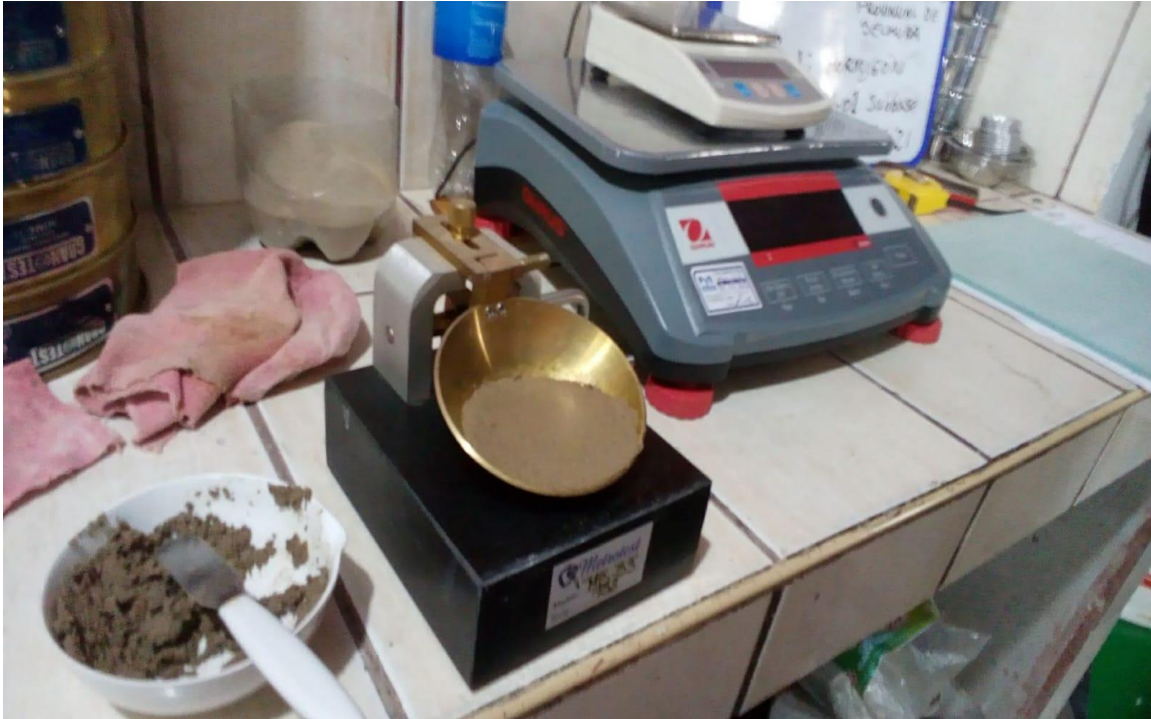
Figura 7: Ensayo de límites de consistencia (ASTM D 4318 / NTP 339.129).
