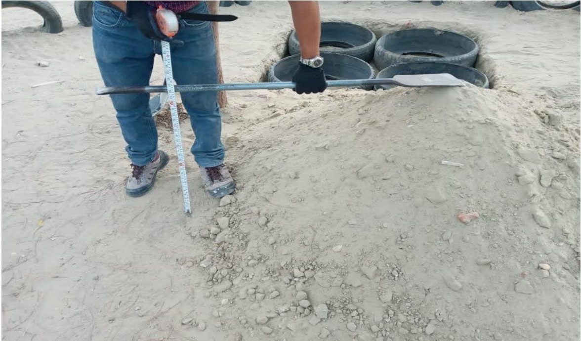
Figura 11. Medida del material extraído para calcular el volumen en la prueba de campo.
