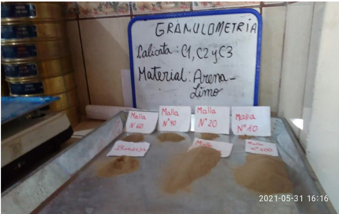
Figura 6: Análisis granulométrico para calicatas C1, C2 y C3 (ASTM D422)
