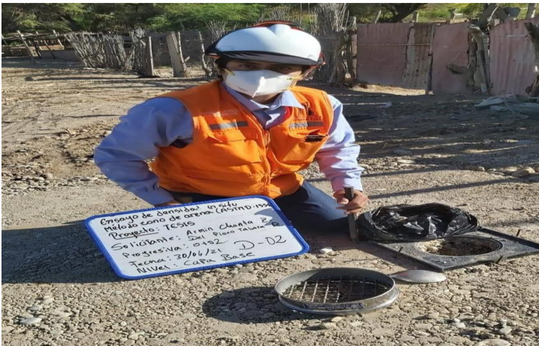
Figura 30. Ensayo de Densidad IN SITU cono de Arena en la capa de método tradicional.
