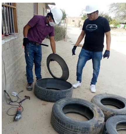
1. Cortar ambos hombros del neumático.
