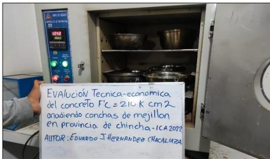
Colocación de desechos de conchas de mejillón en horno a  $110^{\circ}\text{C} \pm 5^{\circ}\text{C}$
