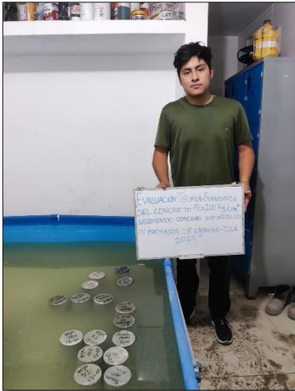
Curado de probetas y viguetas de concreto
