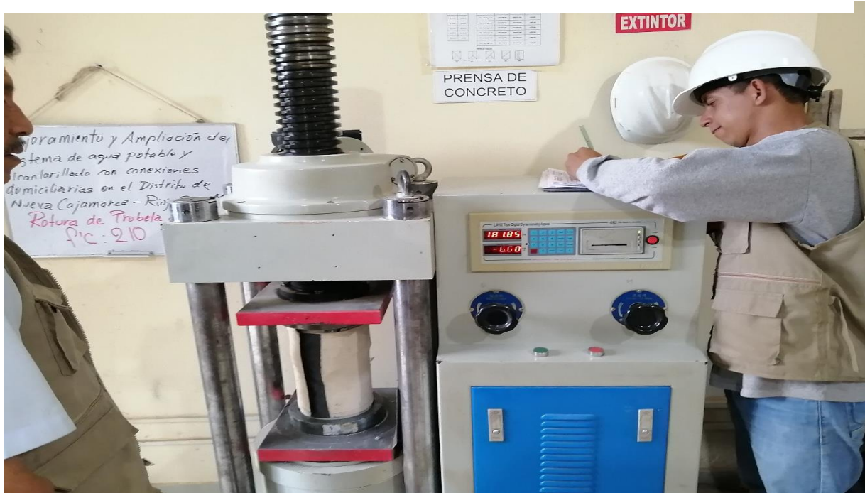
Figura 2. Rotura de probetas de concreto o testigos.
