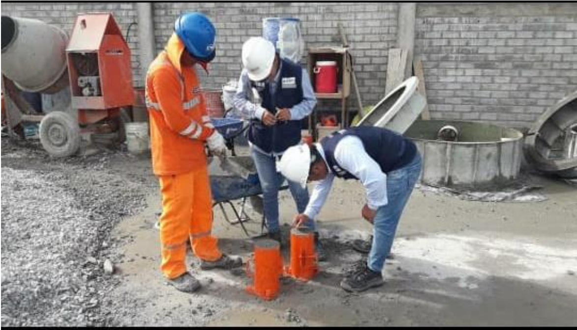
Se observa en la planta de fabricación de los buzones prefabricados tomando dos probetas para determinar la calidad del concreto.
