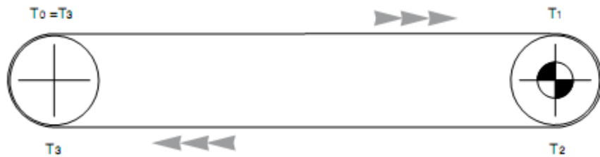
Fig. N° 15: Diagrama de tensiones en tensor de tornillo tambor.
