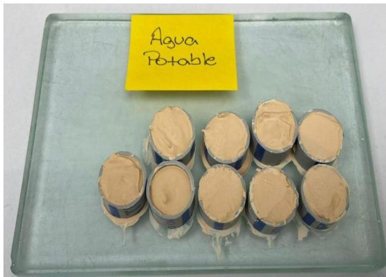
Figura 9. Muestras obtenidas de la mezcla del yeso tipo IV con el agua potable.
