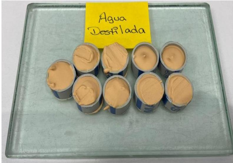
Figura 10. Muestras obtenidas de la mezcla del yeso tipo IV con el agua destilada.
