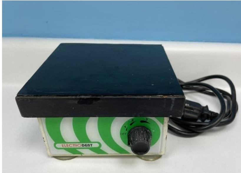
Figura 8. Vibrador usado en la mezcla del yeso con los tipos de agua.
