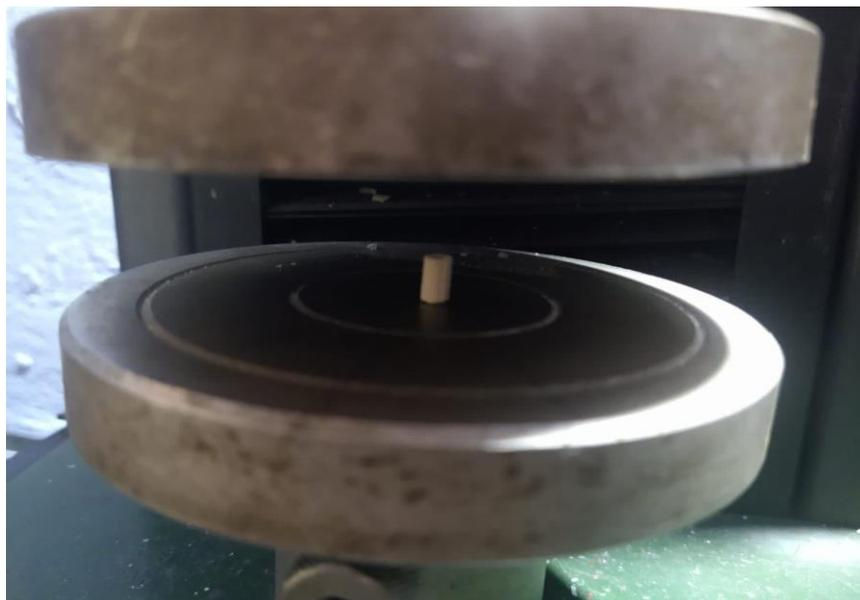
Figura 13. Muestra de yeso en el aparato en el equipo de ensayo universal Instron.
