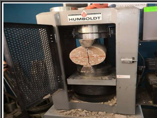
Figura 15. Rotura de briqueta a la edad de 28 días.
