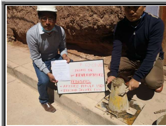
Figura 8. asentamiento del concreto patrón f'c= 210 \text{ kg/cm}^2 .
