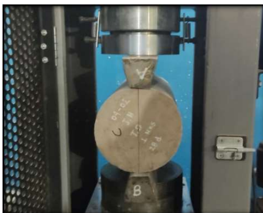
Figura 3. Ensayo a la tracción Fuente: elaboración propia
