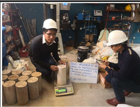
Figura 14. Peso de briquetas antes del ensayo de la tracción indirecta.
