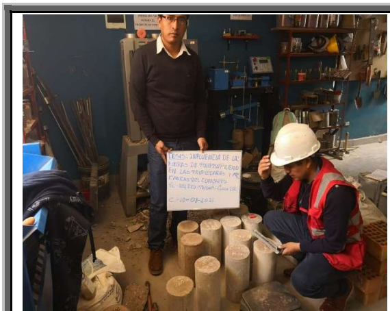
Figura 23. Briquetas para el ensayo de la Tracción indirecta a la edad de 28 días.
