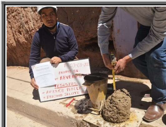
Figura 17. Asentamiento del concreto patrón para un f'c= 280 kg/cm 2 .
