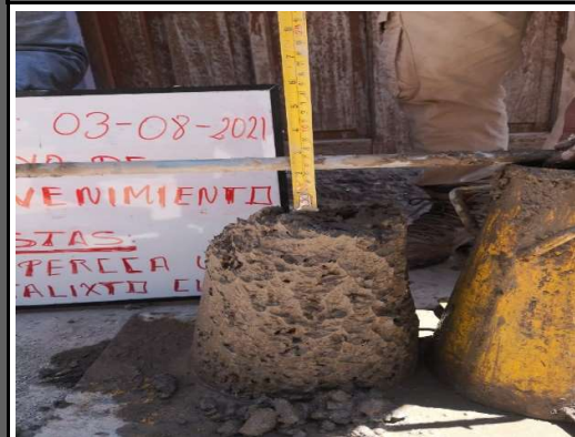
Figura 18. Asentamiento del concreto con una proporción de 0.10% de fibra de polipropileno.
