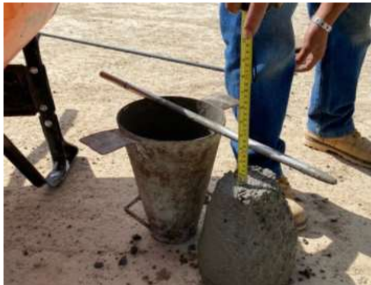
Figura 1. Ensayo del asentamiento Fuente: elaboración Propia
