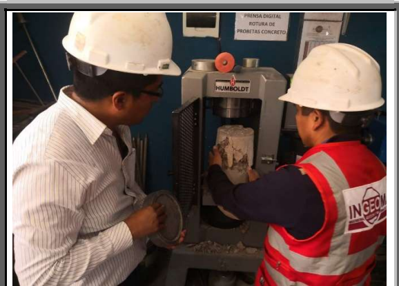
Figura 21. Rotura de briqueta a la edad de 28 días.
