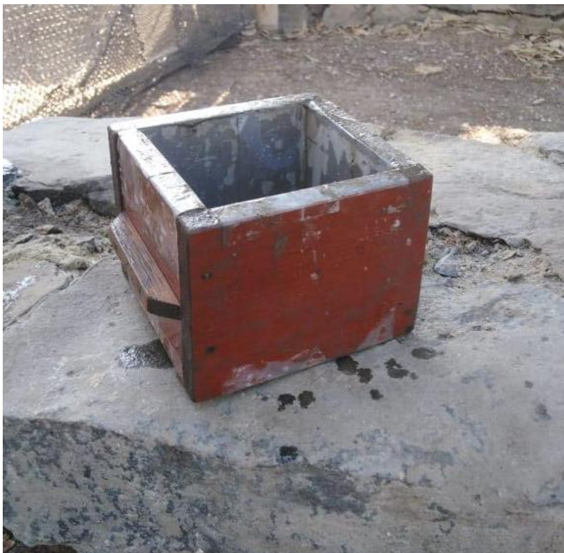
Figura N°10: Molde para los cubos
