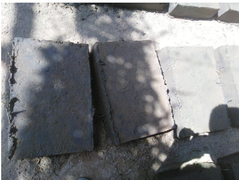
Figura N°14: Desmoldado del adobe experimental con adición de 5% de paja de arroz.
