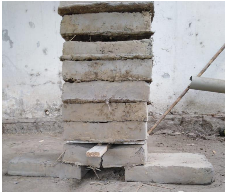
Figura N°26: Ruptura de resistencia por aplastamiento de los adobes patrón y experimental.
