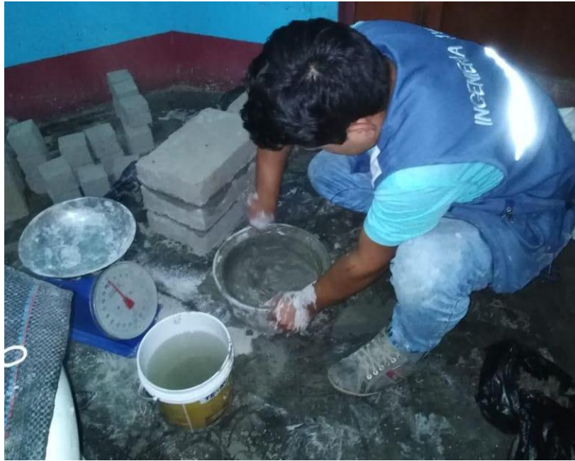
Figura N°21: Elaboración de las pilas a una altura de tres adobes.
