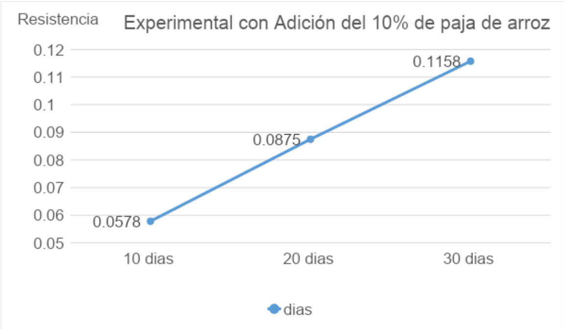
Gráfica N°5: Resistencia por aplastamiento del adobe experimental con adición del 10% de paja de arroz.
