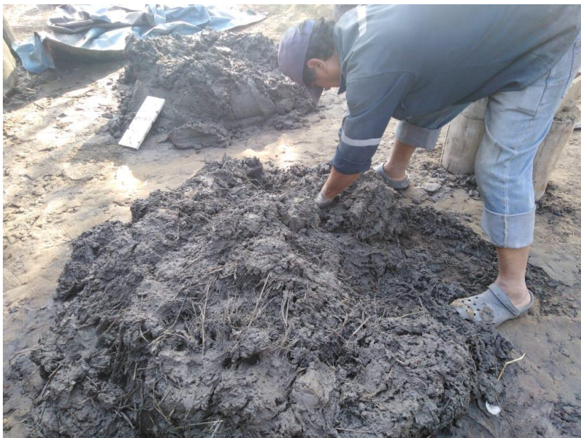
Figura N°12: Mezclado del adobe experimental con 5% de paja de arroz.
