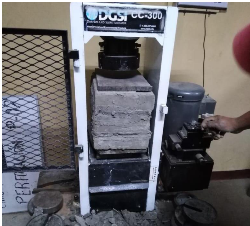
Figura N°24: Ensayo de resistencia a la compresión de las pilas.
