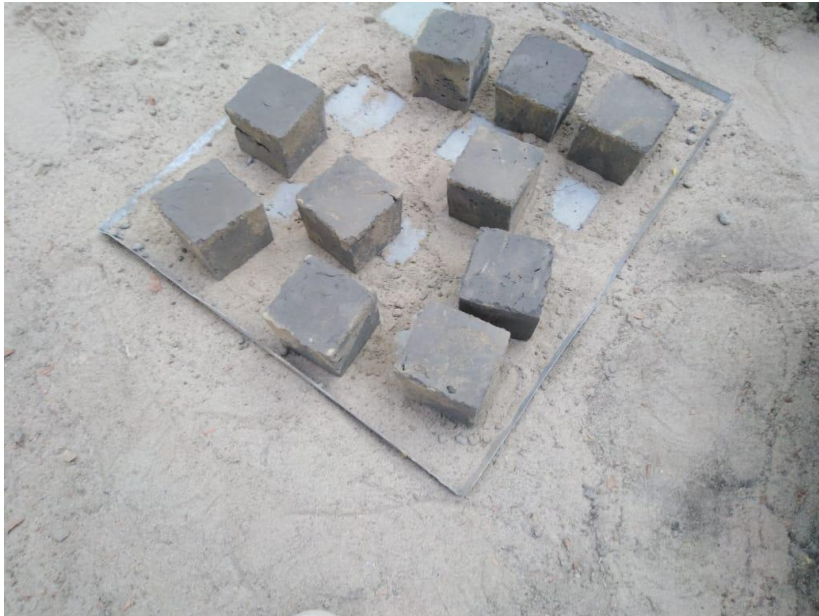
Figura N°11: Desmoldado de los dados de adobe patrón.
