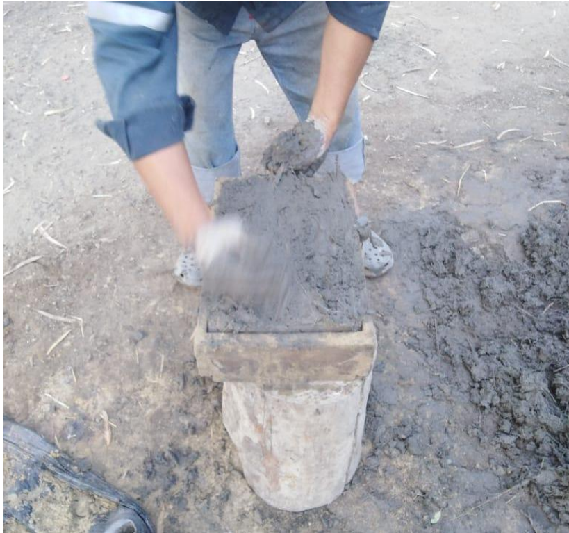
Figura N°7: Llenado de la mezcla patrón en molde.
