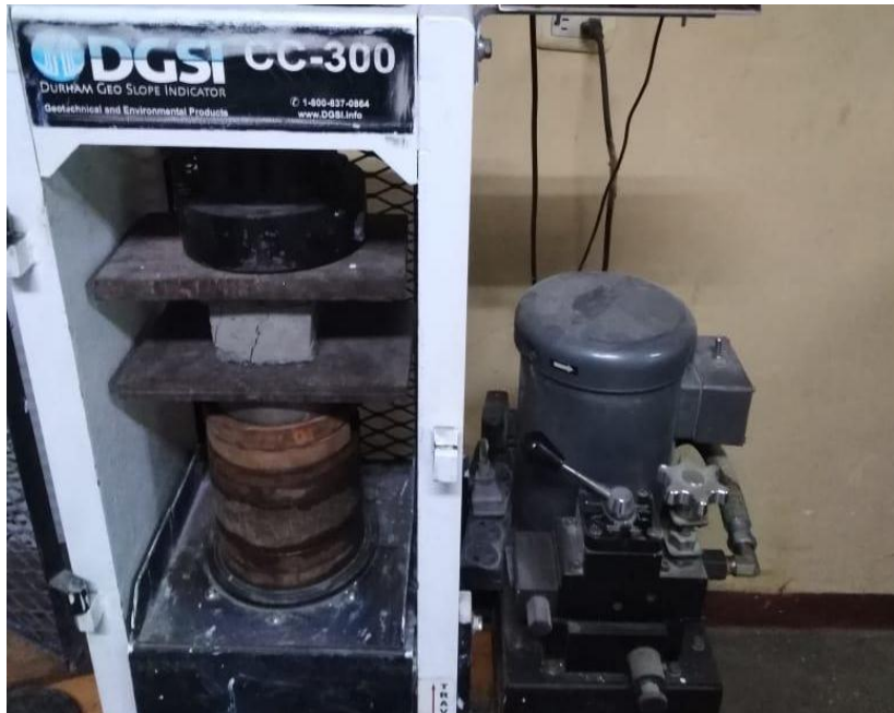
Figura N°23: Ensayo de resistencia a la compresión de cubos.
