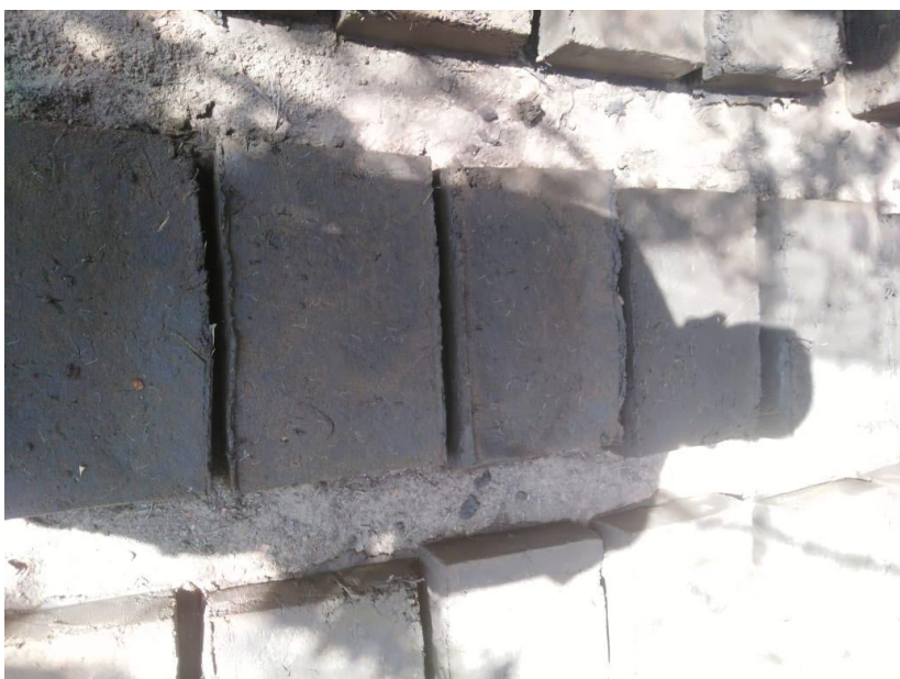
Figura N°18: Desmoldado del adobe experimental con adición de 10% de paja de arroz.
