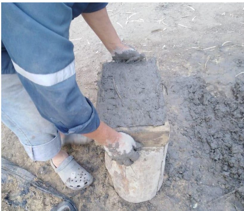
Figura N°13: Llenado del adobe experimental con adición de 5% de paja de arroz en molde.
