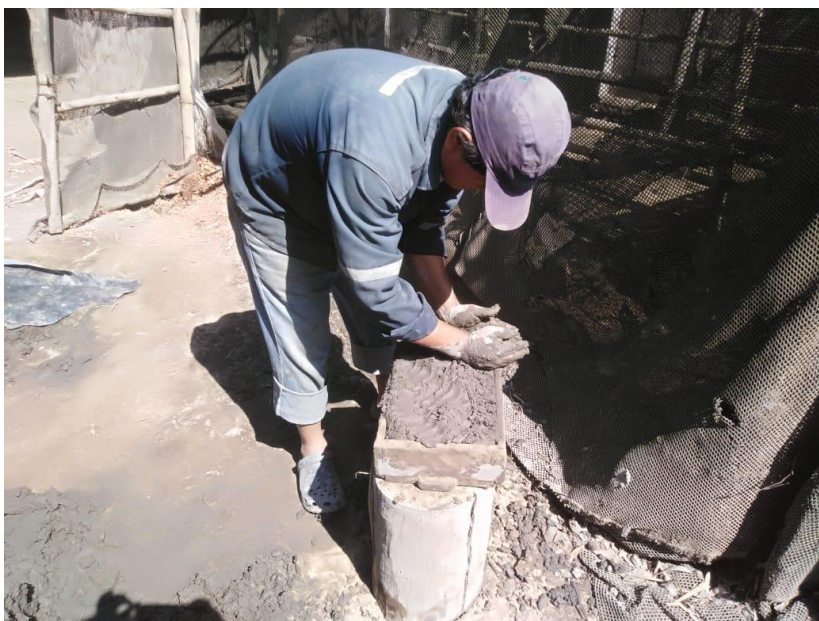
Figura N°17: Llenado del adobe experimental con adición de 10% de paja de arroz en molde.
