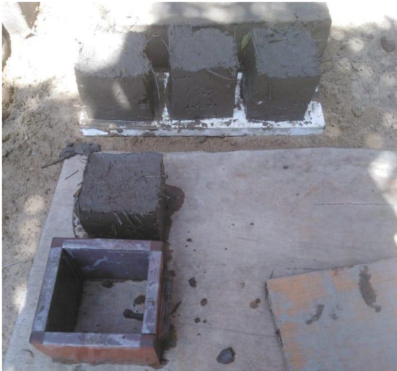
Figura N°19: Desmoldado de los dados experimentales con adición de 10% de paja de arroz.
