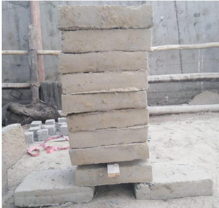
Figura N°25: Ensayo de resistencia por aplastamiento de los adobes patrón y experimental.
