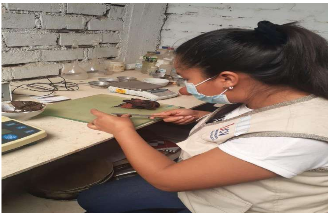
Figura 13: Ensayo de Límite plástico con muestra de suelo natural, 2021
