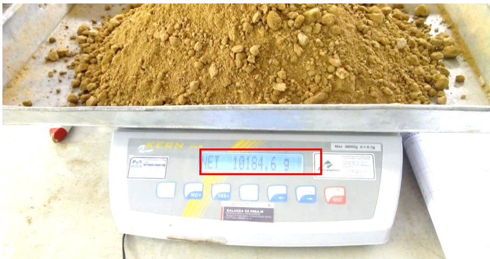
Fig. N° 13 – Muestra tomada para el ensayo de Contenido de Humedad.
