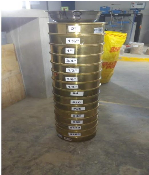
Fig. N° 9 – Dimensiones de tamices utilizados en el laboratorio de E.M.S
