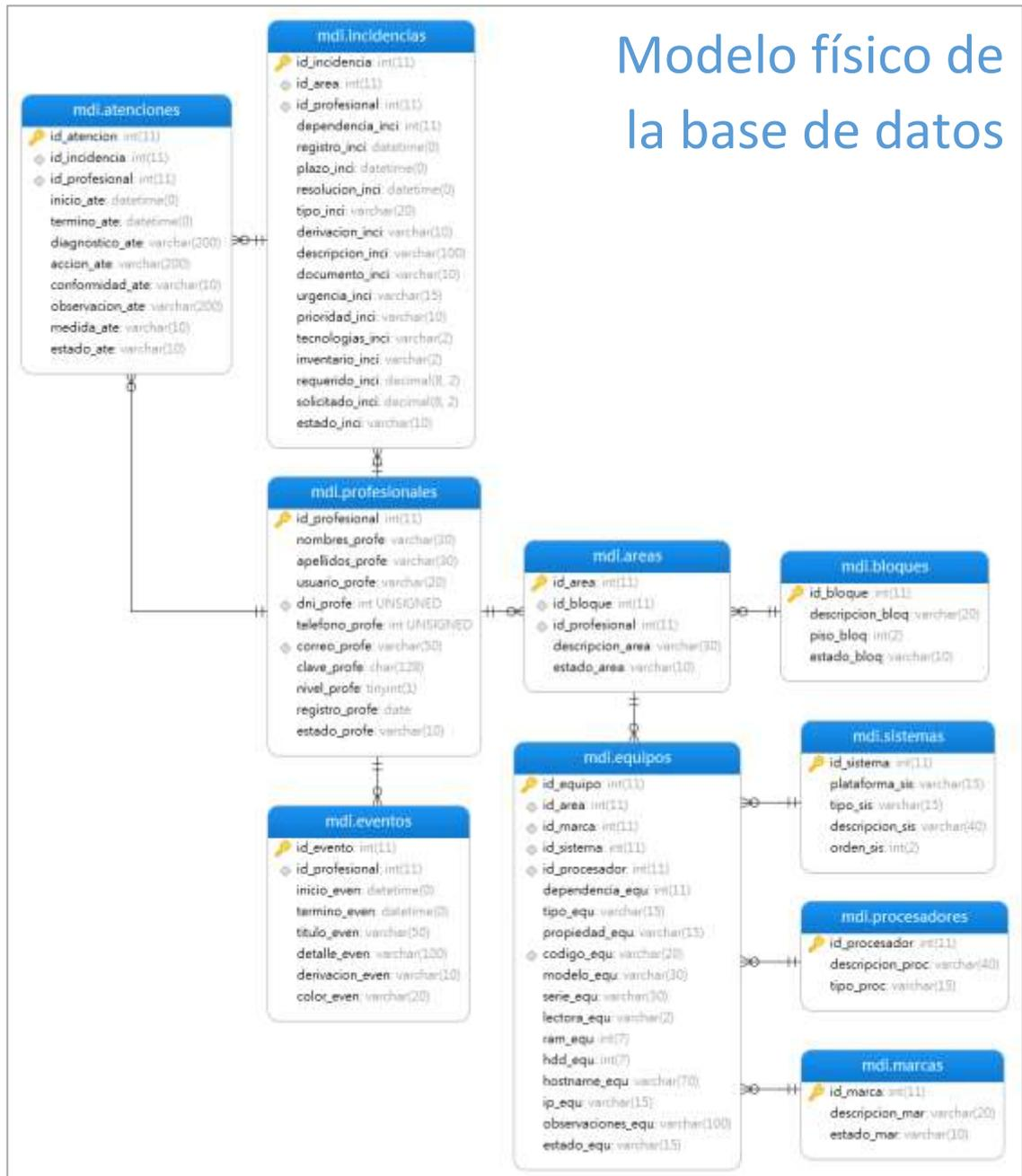
Figura 11: Modelo físico de la base de datos
