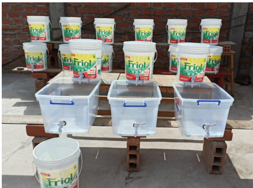
Figura 20. Instalación de los humedales artificiales de flujo continuo para los tres tratamientos
