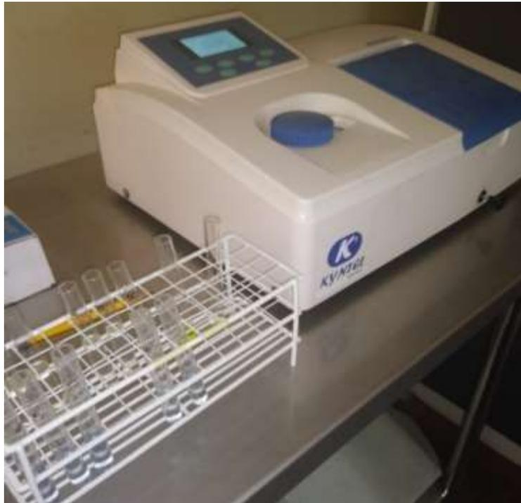
**Figura 25.** Lectura del espectrofotómetro Kyntel KV 1200
