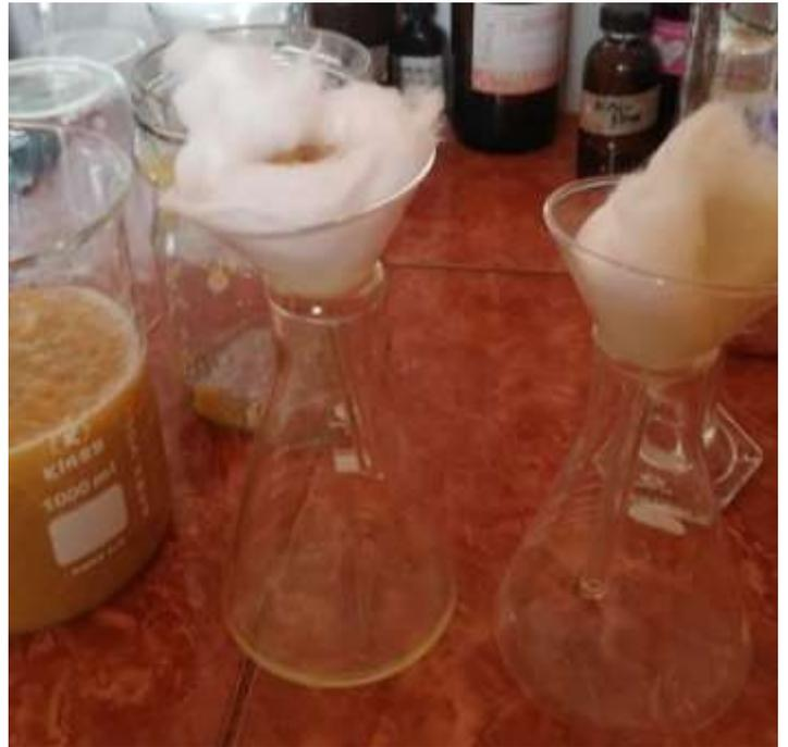
**Figura 11.** Filtración del extracto hidroalcohólico.
