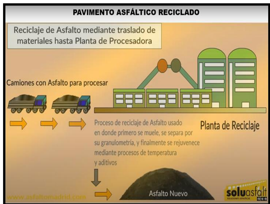
Figura 1. Reciclaje del pavimento asfáltico
