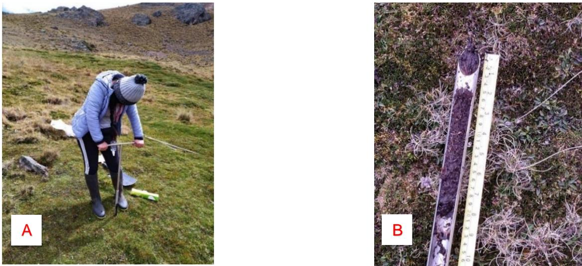
**Figura 5:** (A) Extracción de la turba con ayuda de un barreno, (B) Medición de la cantidad de turba con una wincha.
