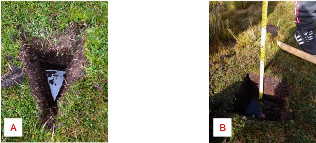
**Figura 3:** (A) Hoyo para medir el nivel de napa freática, (B) Medición del nivel de napa freática con ayuda de una wincha.
