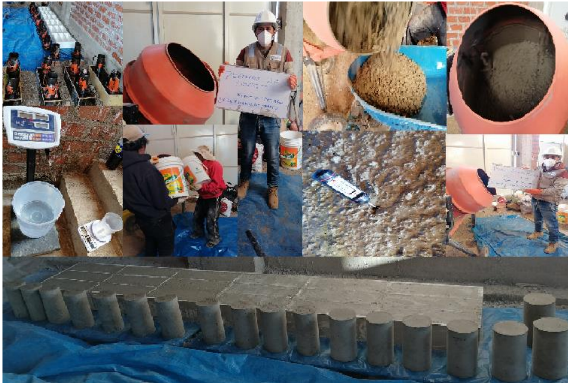
6.- Elaboración del concreto hidráulico según ASTM C 31
