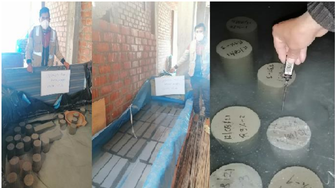
7.- Curado del concreto hidráulico según ASTM C 31
