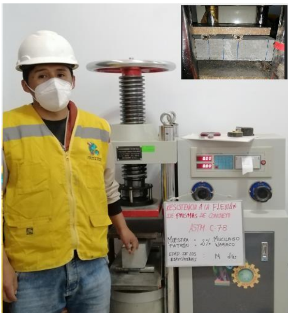
11.- Ensayo de Resistencia a la flexión (ubicación de la falla de especímenes prismáticos) ASTM C 78
