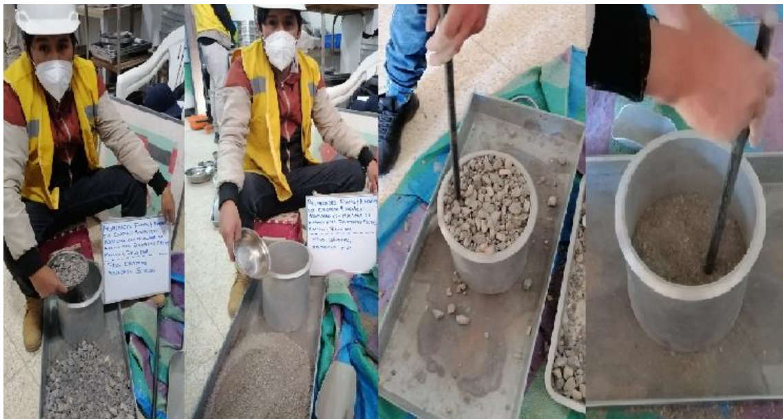
6.- Peso unitario o varillado del agregado fino y grueso según ASTM C 29
