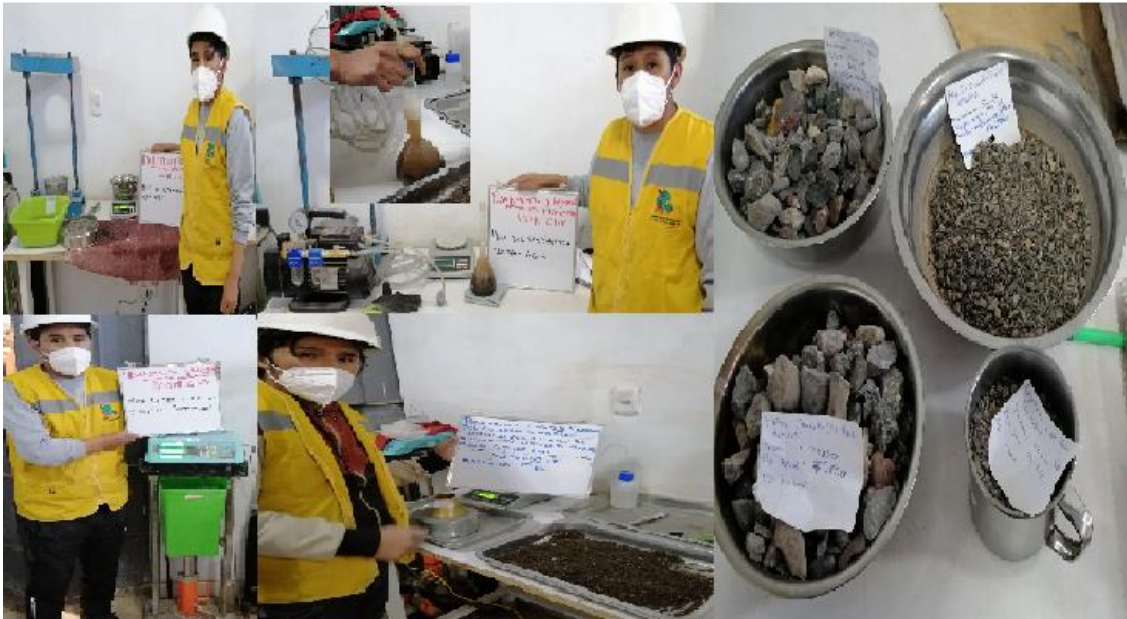
5.- Contenido de humedad, peso específico y absorción del agregado fino y grueso según ASTM C 566, C 128 y C 127
