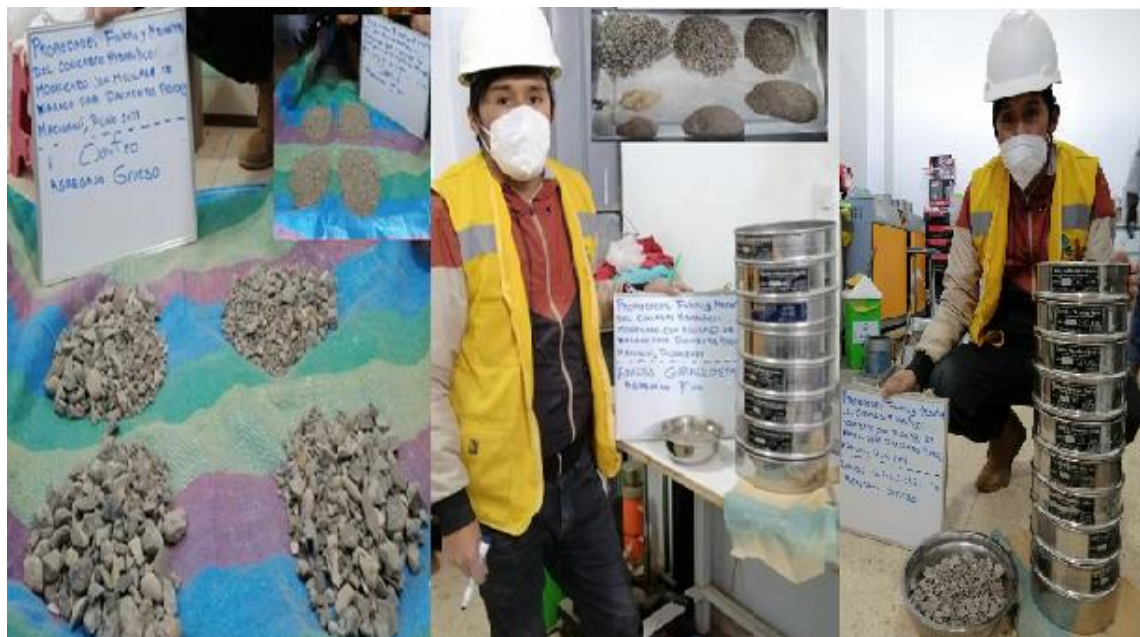
4.- Cuarteo y análisis granulométrico según ASTM C 702 y C 136
