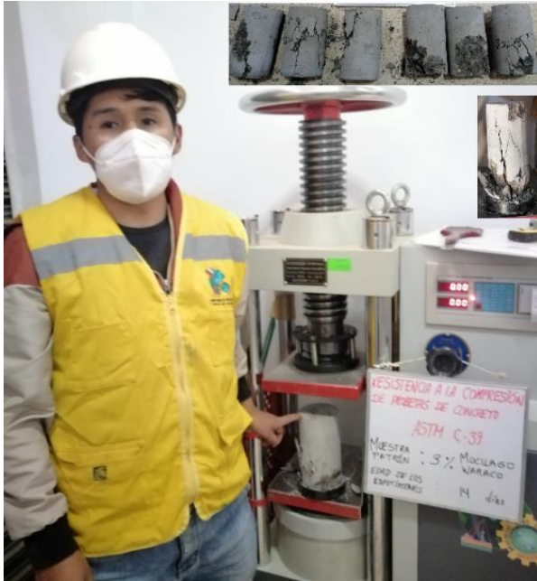
10.- Ensayo de Resistencia a la compresión (Tipos de falla de especímenes cilíndricos) según ASTM C 31
