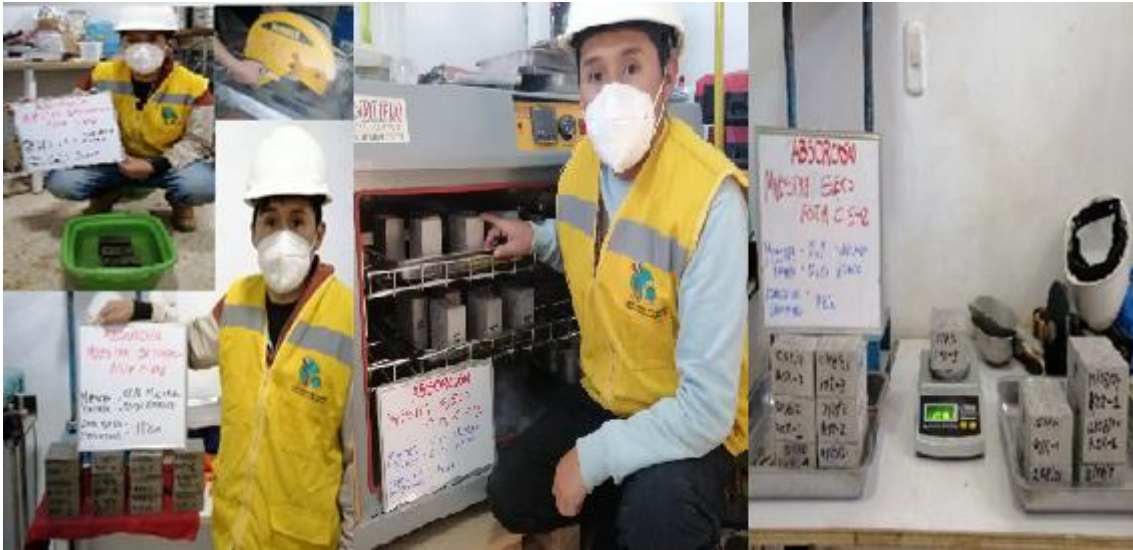
9.- Prueba de absorción (núcleos de vigas) según ASTM C 642
