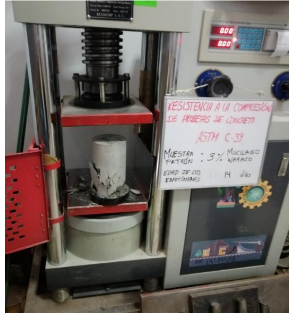
10.- Ensayo de Resistencia a la compresión (Tipos de falla de especímenes cilíndricos) según ASTM C 31
