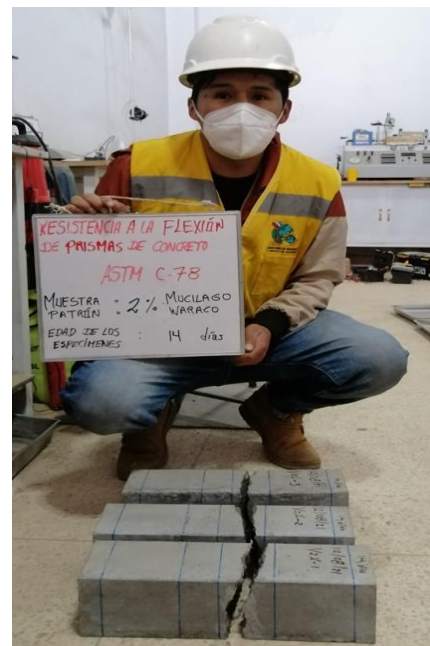
11.- Ensayo de Resistencia a la flexión (ubicación de la falla de especímenes prismáticos) ASTM C 78
