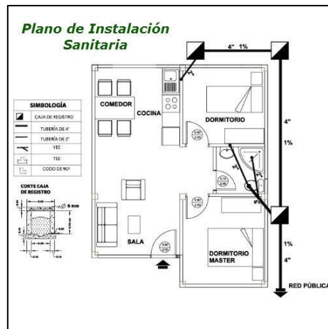
Figura N°4: Plano de Instalaciones Sanitarias
