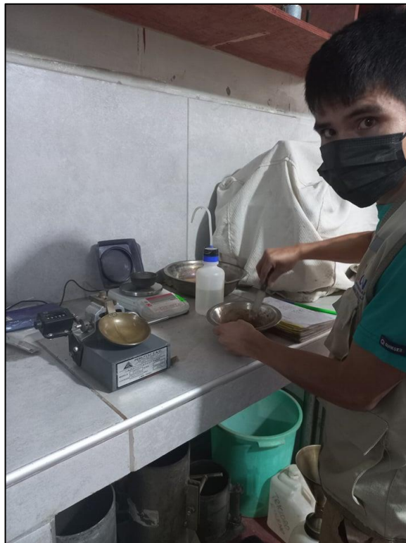
Foto N°10: Ensayo de copa Casagrande (límite líquido)
