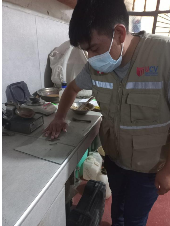
Foto N°11: Ensayo de límite plástico
