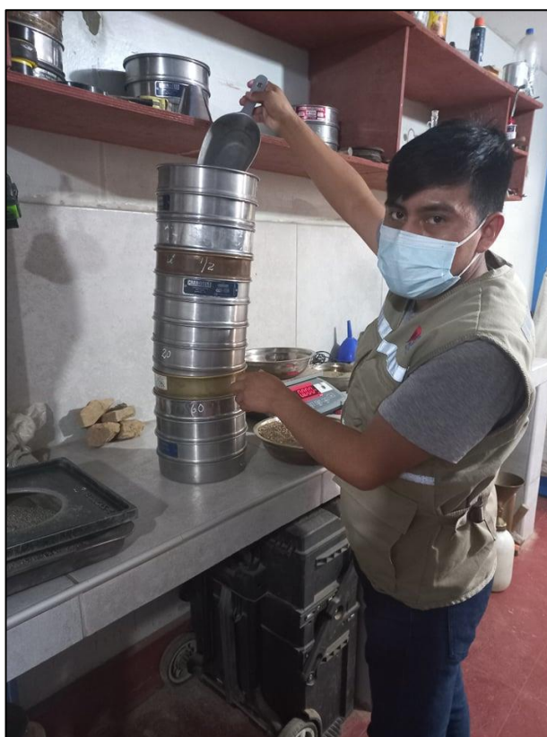
Foto N°6: Tamizado de las muestras extraídas en las calicatas
