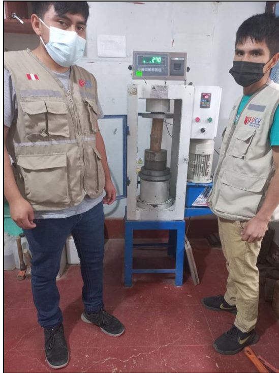
Foto N°9: Aplicación de la presa hidráulica para las propiedades mecánicas del bambú
