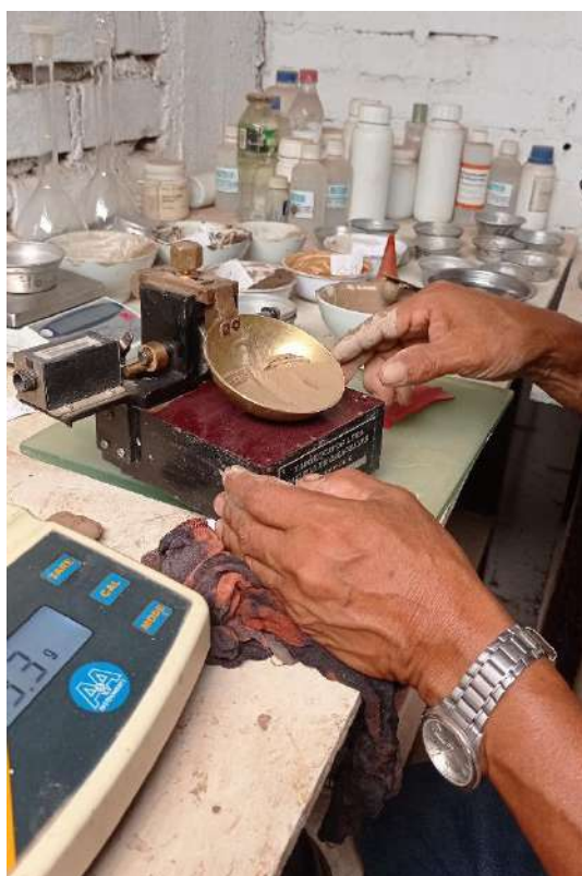
Figura 22: Ensayo de limite líquido para determinar el índice de plasticidad del suelo estabilizado.
