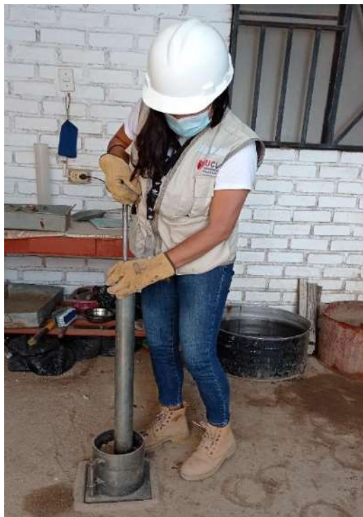
Figura 24: Ensayo de Proctor modificado del suelo natural para determinar la resistencia, 2021.
