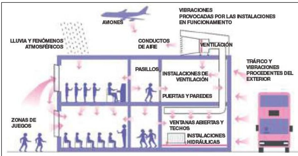
*Nota.* Los pasadizos y los muros funcionan como amortiguadores acústicos, así como también la ubicación de ventanas en lugares adecuados. Fuente: <https://construccionyrehabilitacion.com/2018/10/28/como-se-elige-el-aislamiento-acustico-de-paredes-techos-pavimentos-e-instalaciones/>
