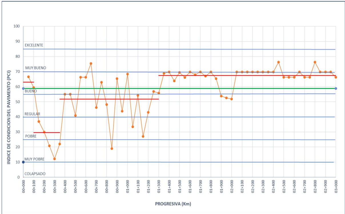
Figura 21. Sectorización de tramos puntos localizados.
