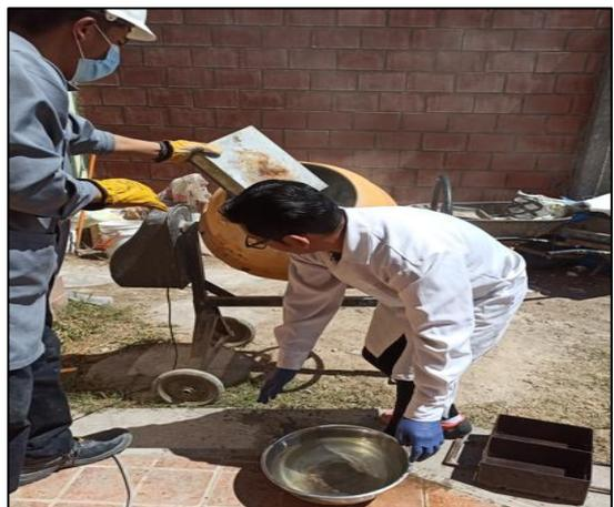
Colocación de los materiales en la mezcladora
