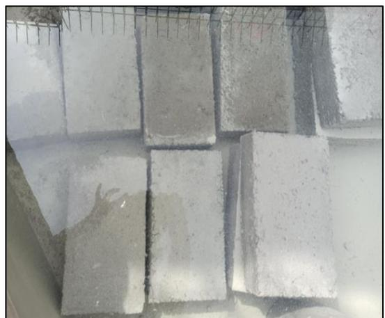
Curado de ladrillos de concreto
