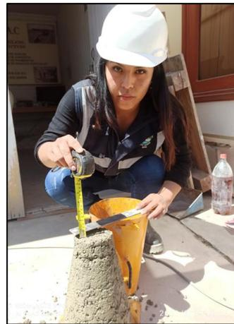
Ensayo de revenimiento de la mezcla de concreto
