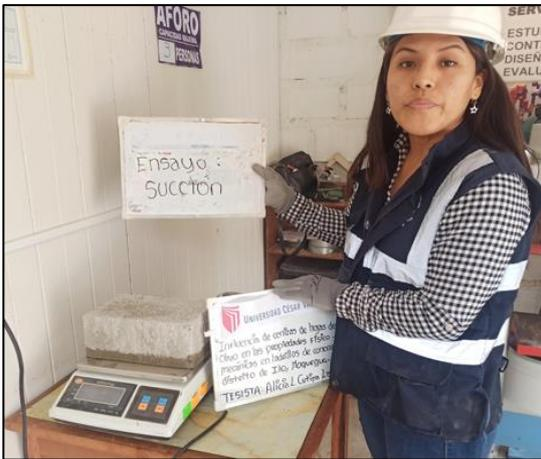
Pesado de ladrillo – Ensayo de succión
