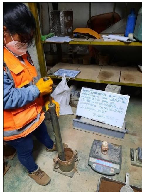
Figura 30. Ensayo Próctor Modificado – muestra con 0.20% con aditivo de organosilanos.
