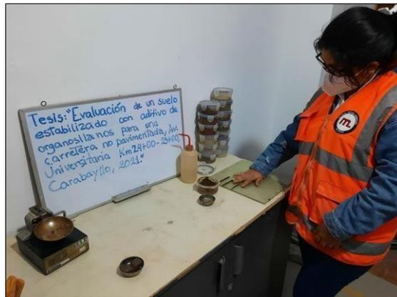
Figura 23. Ensayo para determinar el Limite Plástico
