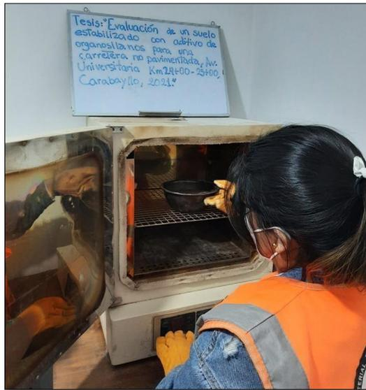
Figura 21. Secado de la muestra para el Análisis Granulométrico
