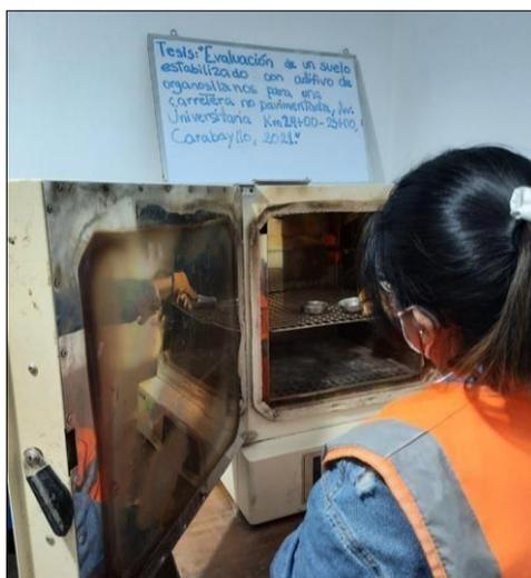
Figura 25. Secado de la muestra para el ensayo Límites de Atterberg
