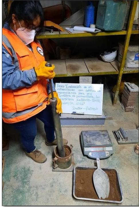
Figura 27. Ensayo Próctor Modificado – muestra sin de aditivo de organosilanos (muestra patrón)
