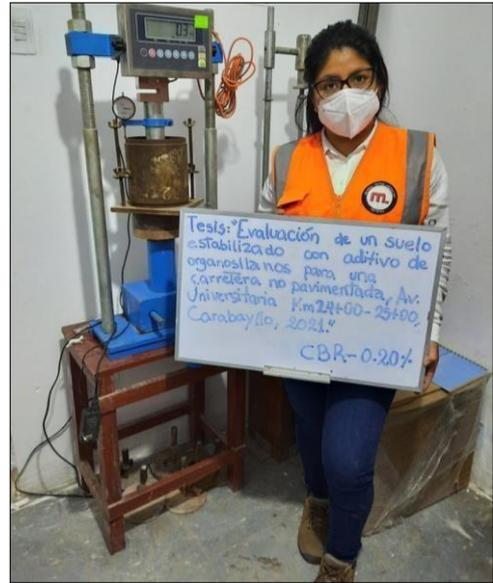
Figura 35. Ensayo CBR – muestra con 0.20% de aditivo de organosilanos
