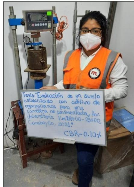
Figura 33. Ensayo CBR – muestra con 0.10% de aditivo de organosilanos
