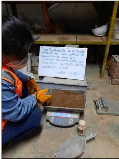
Figura 11. Ensayo Próctor Modificado
