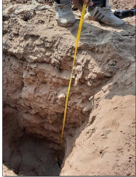
Figura 18. Inspección visual del perfil estratigráfico y verificación de la profundidad de excavación
