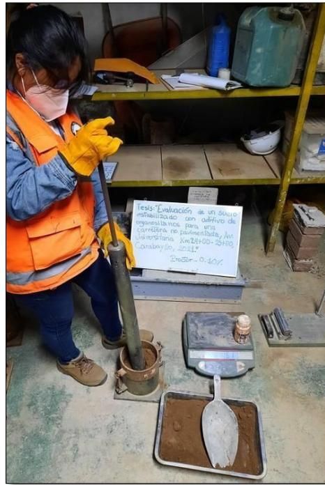
Figura 28. Ensayo Próctor Modificado – muestra con 0.10% de aditivo de organosilanos
