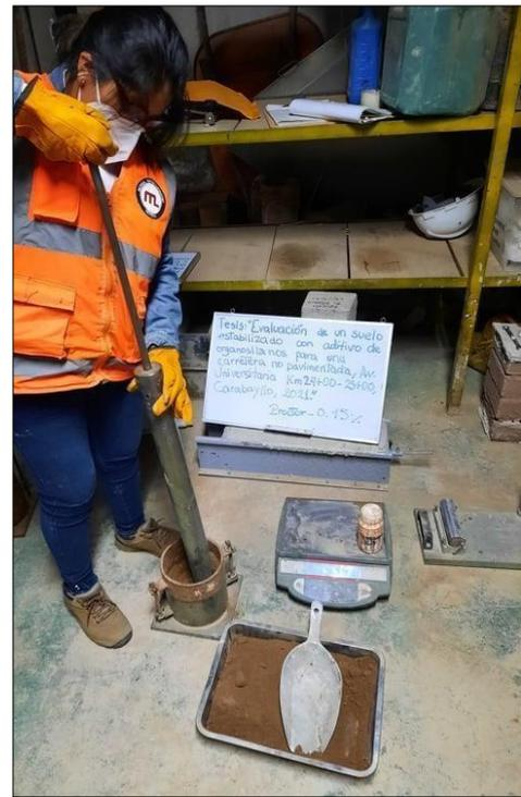
Figura 29. Ensayo Próctor Modificado – muestra con 0.15% de aditivo de organosilanos
