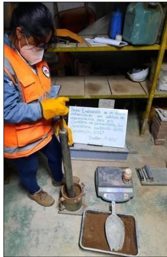
Figura 12. Ensayo Próctor Modificado
