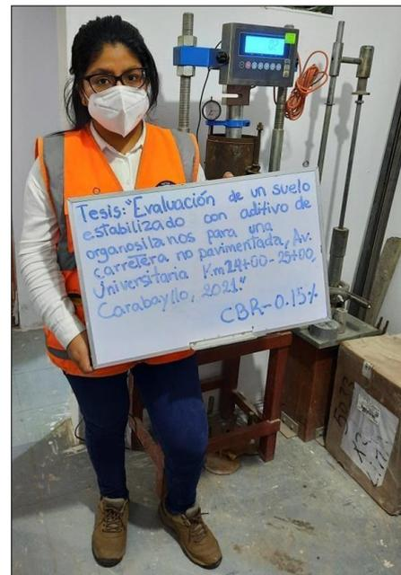
Figura 34. Ensayo CBR – muestra con 0.15% de aditivo de organosilanos
