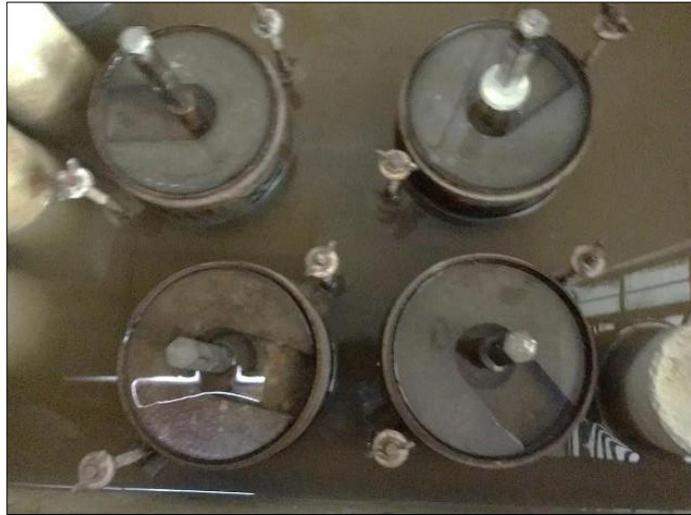
Figura 31. Inmersión de la muestra para el ensayo CBR
