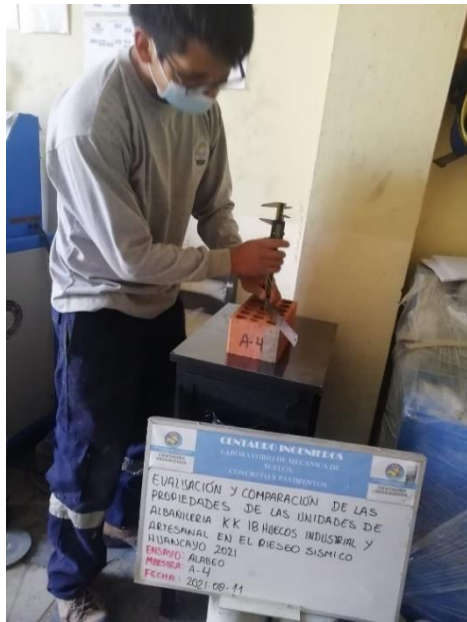
Figura 15. Ladrillo A-4 ensayado.
