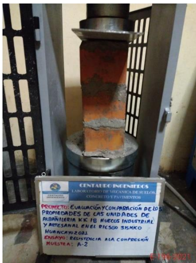
Figura 12. Prisma en ensayo.
