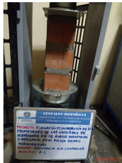
Figura 13. Prisma sometido a esfuerzos.
