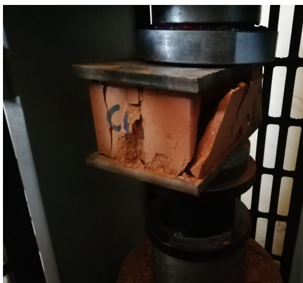
Figura 10. Rotura del ladrillo cocharcas
