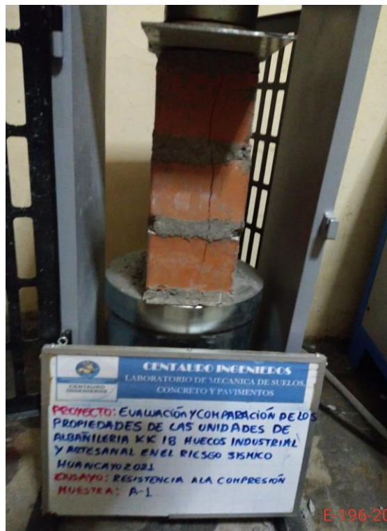
Verificando las unidades de albañilería
