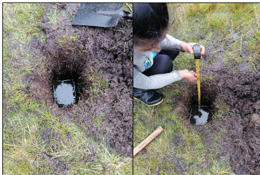
Figura 6. Medición de la napa freática
