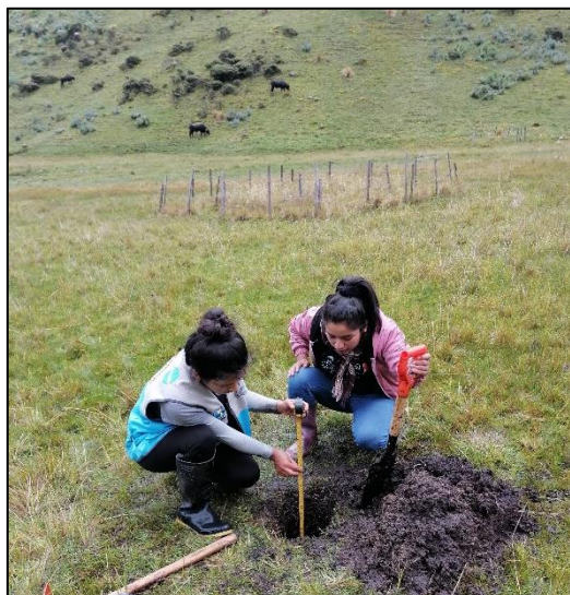
Figura 7. Medición de profundidad de turba
