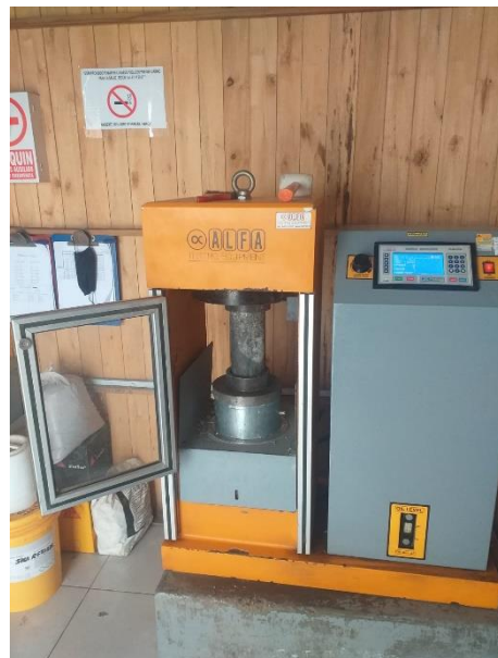
Figura 16: Ensayo de rotura de probeta
