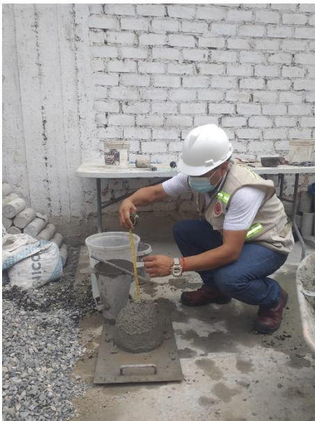
Figura 15: Slump del concreto
