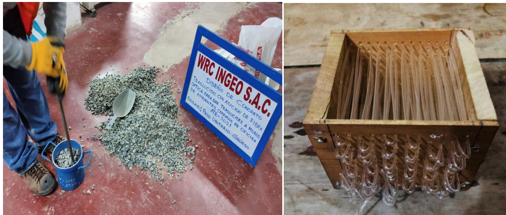
Figura 16: Agregado y tejido de la fibra óptica
