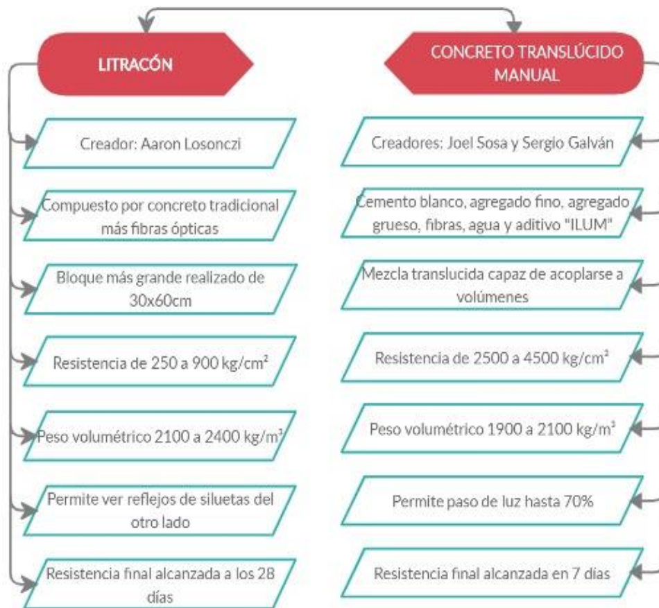
Figura 7: Características de dos tipos de concreto translucidos
