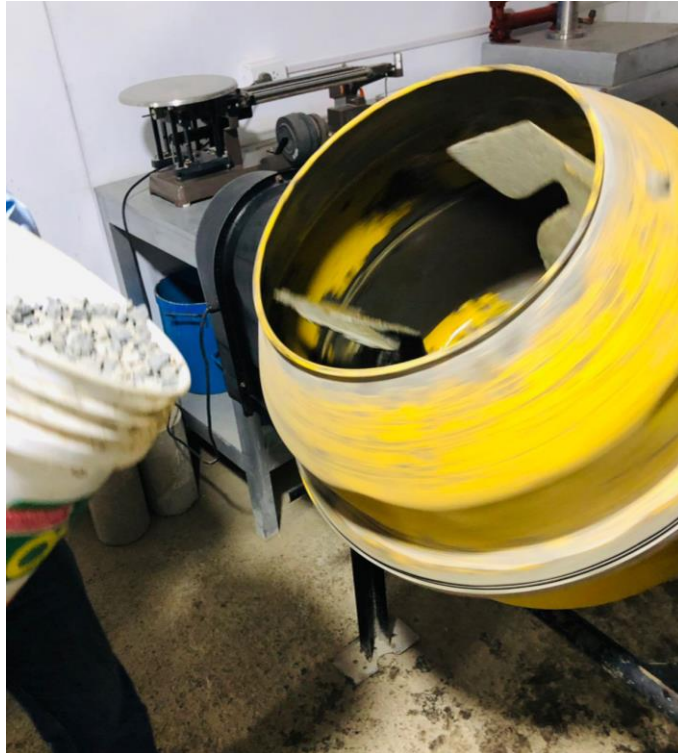
Anexo 7: Realización de la mezcla del concreto con un diseño de 210 \text{kg}/\text{cm}^2
