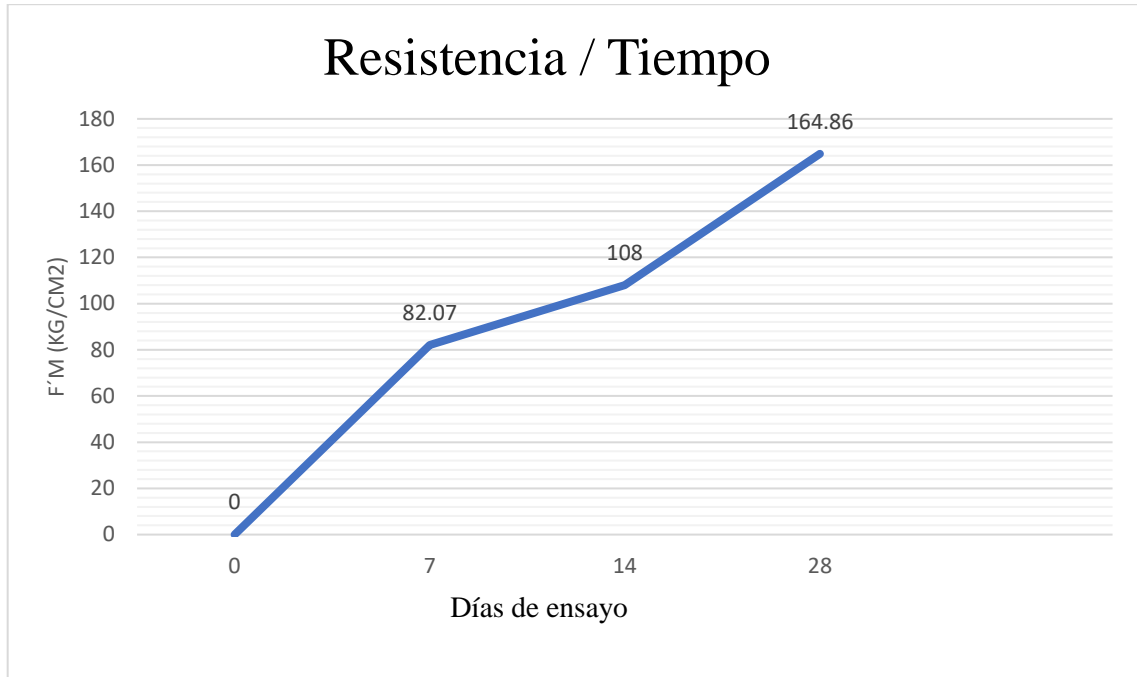
Figura N° 24: Resultados del ensayo de resistencia a compresión en pilas.
