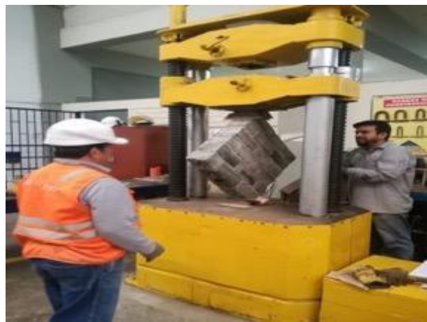
Figura N° 28: Ensayo de resistencia a compresión en muretes.
