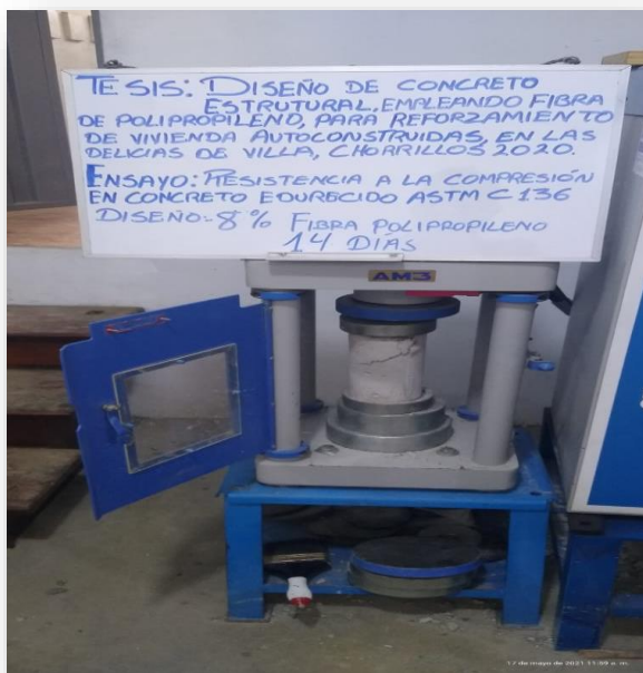
Figura 61. Resistencia a la compresión 8% de fibra de polipropileno 14 días.
