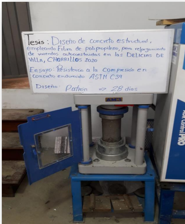
Figura 67. Resistencia a la compresión concreto patrón 28 días.
