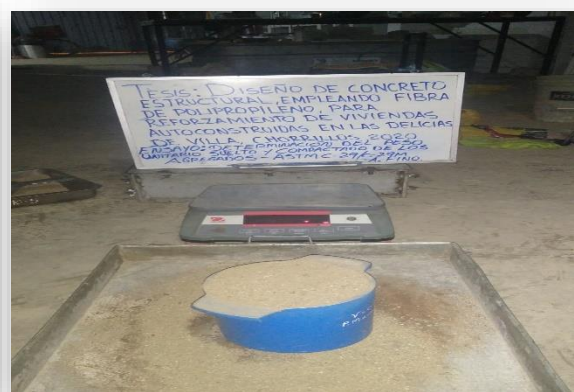
Figura 38. Ensayo determinación del peso unitario.
