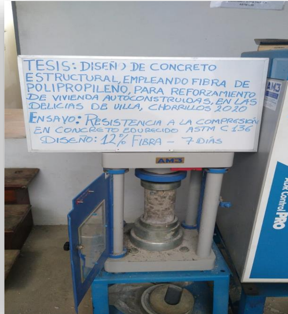
Figura 54. Resistencia a la compresión 12% fibra de polipropileno.
