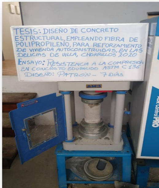
Figura 51. Resistencia a la compresión concreto patrón 7 días.
