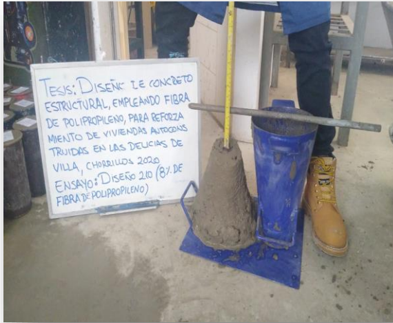
Figura 47. Diseño 210 con 8% de fibra de polipropileno.
