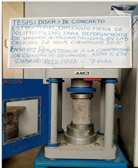
Figura 53. Resistencia a la compresión 8% fibra de polipropileno 7 días.
