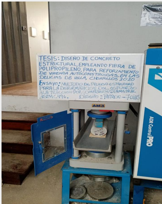
Figura 55. Resistencia a la tracción concreto patrón 7 días.
