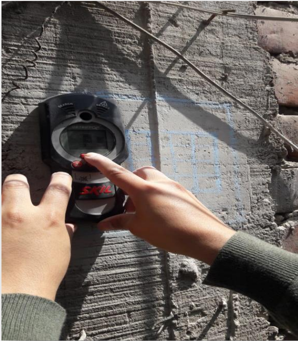
Figura 79. Detector de varillas en vivienda 1.
