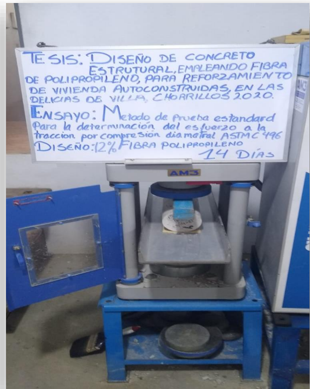
Figura 66. Resistencia a la tracción 12% fibra de polipropileno 14 dias.
