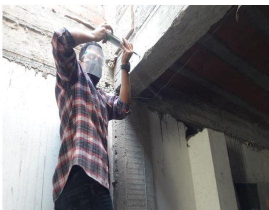
Figura 11. Prueba de martillo esclerométrico.
