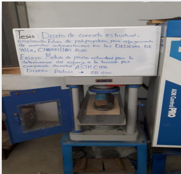
Figura 71. Resistencia a la tracción concreto patrón 28 días.
