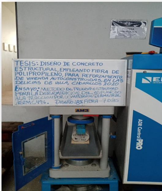
Figura 57. Resistencia a la tracción 8% de fibra de polipropileno 7 días.
