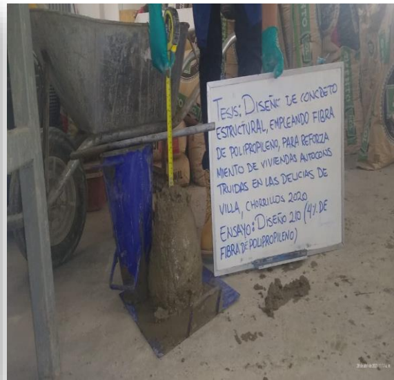
Figura 46. Diseño 210 con 4% fibra de polipropileno.
