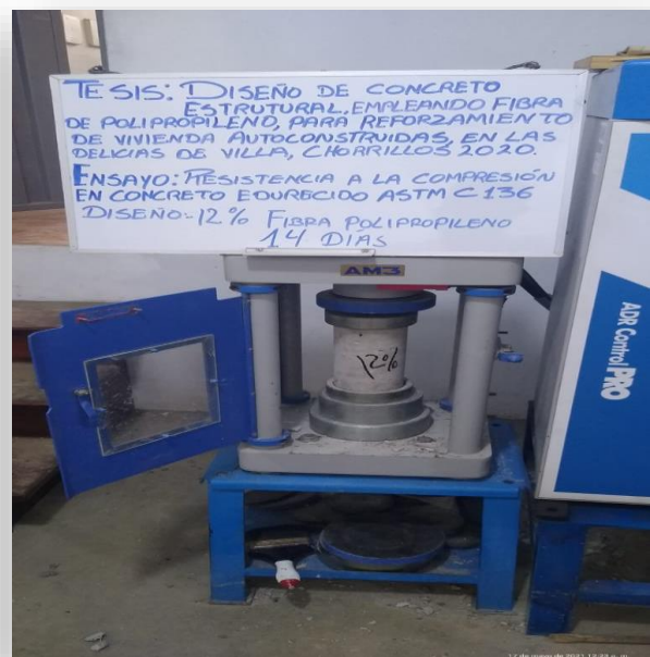
Figura 62. Resistencia a la compresión 12% de fibra de polipropileno 14 días.
