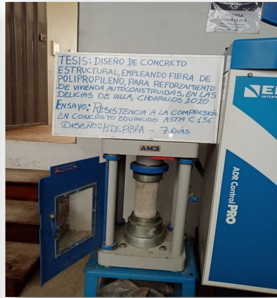
Figura 52. Resistencia a la compresión 4% fibra de polipropileno 7 días.
