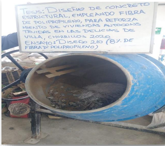
Figura 43. Diseño de 8% con fibra de polipropileno.
