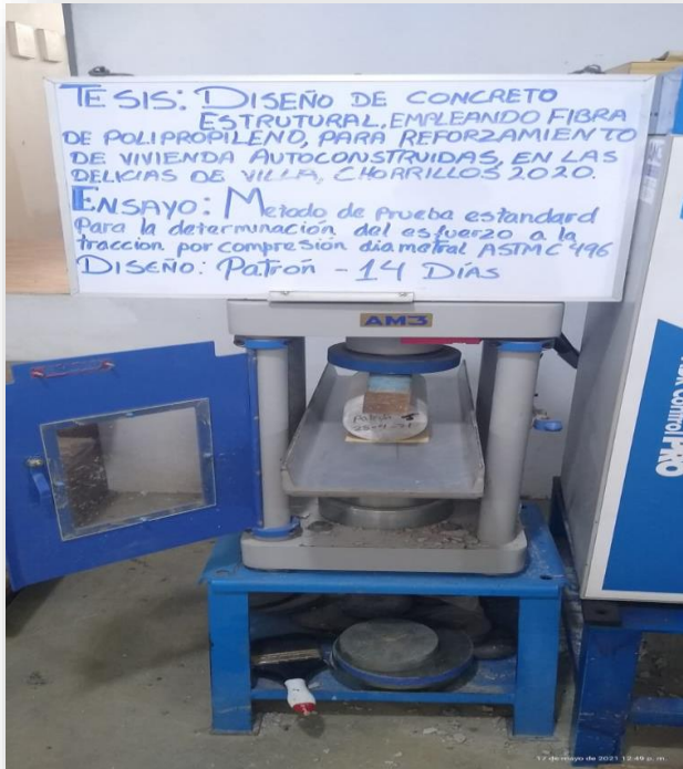
Figura 63. Resistencia a la tracción concreto patron 14 dias.
