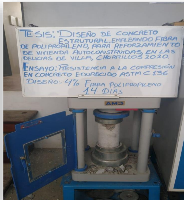
Figura 60. Resistencia a la compresión 4% de fibra de polipropileno 14 días.
