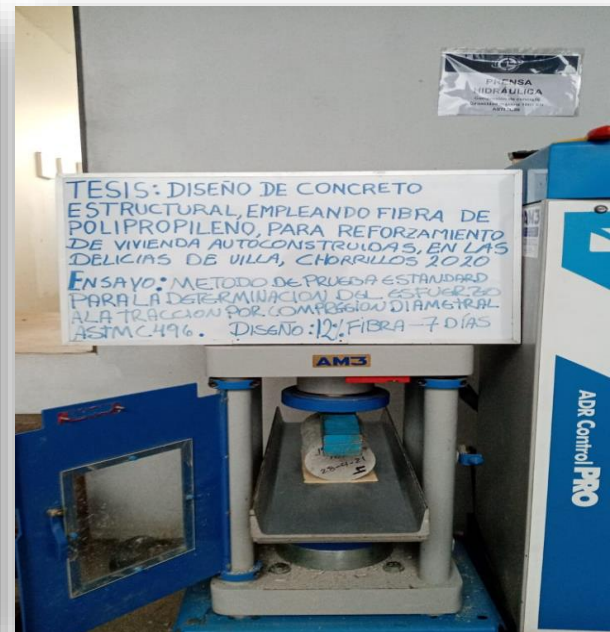
Figura 58. Resistencia a la tracción 12% de fibra de polipropileno 7 días.
