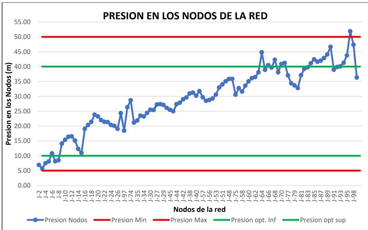
Figura 21. Histograma de Presiones en los Nodos de la Red de Distribución
