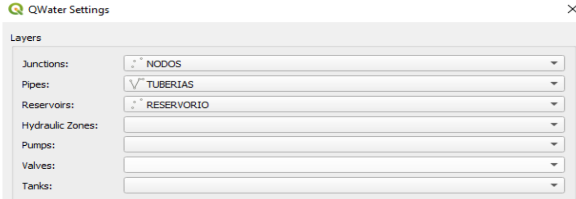
Figura 16. Configuración de Elementos Vectoriales como Elementos Hidráulicos
