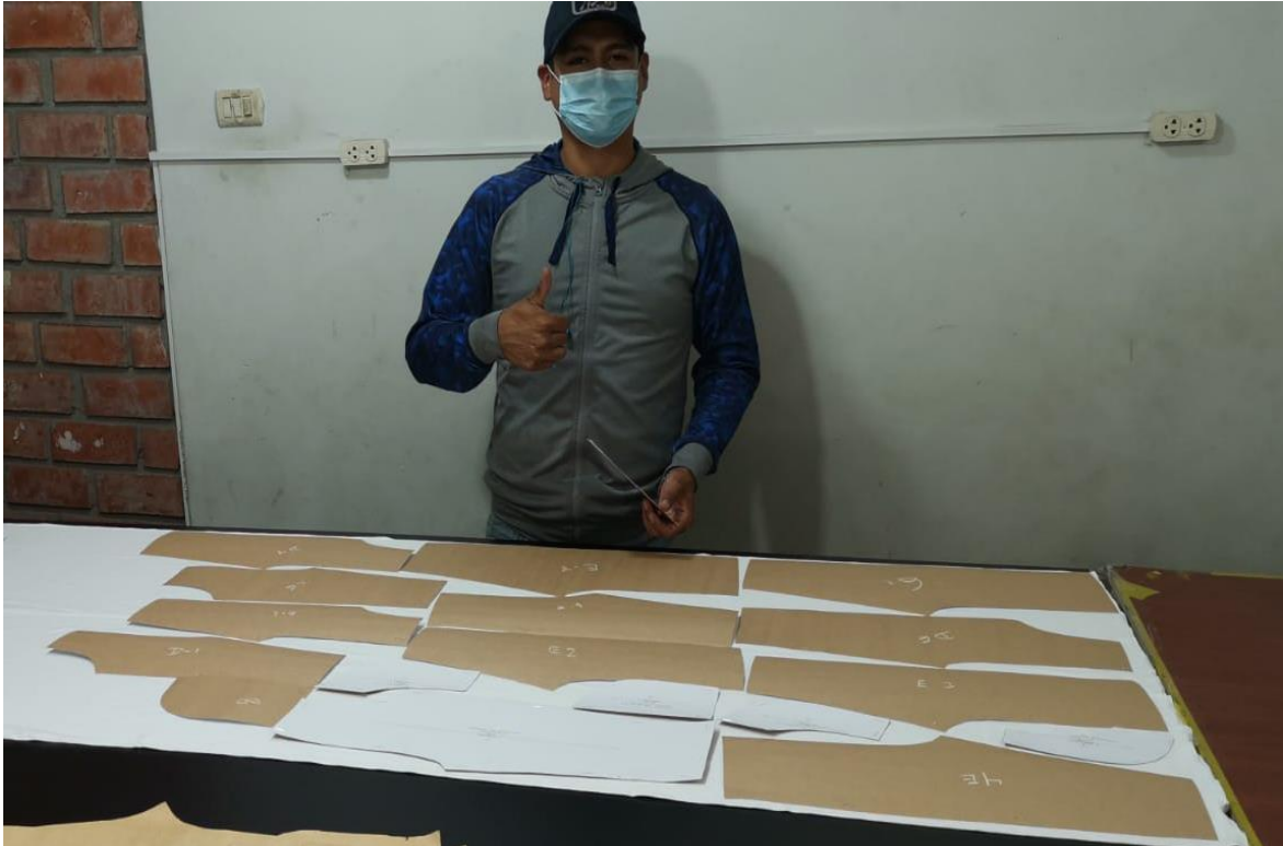
Figura 23. Colocado de moldes sobre la tela tendida
