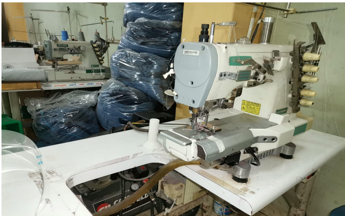
Figura 49. Falta de limpieza máquina de coser
